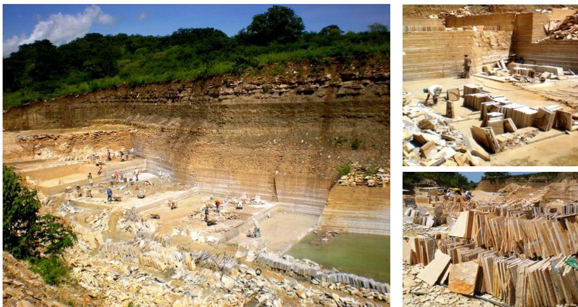
**Figura 3.1.** Explorações da “Pedra Cariri”, Membro Crato. **A-** Frente de lavra do calcário laminado em forma de salão, conduzida de modo seletivo a céu aberto; **B-** pormenor do avanço de frente de lavra, utilização de serras de corte, retirada manual do material e empilhamento; **C-** organização das lajes de calcário para posterior comercialização.
