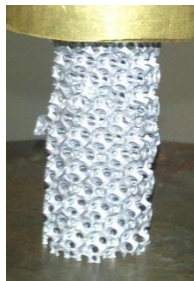
Figura 3.30 – Espuma de células dual-size sem parede
