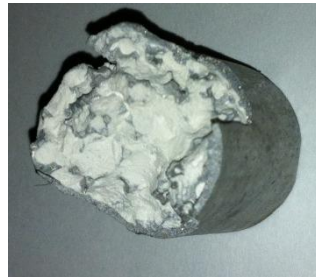
Figura 3.36 – Gesso no interior da espuma dual-size
