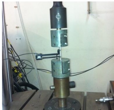
Figura 3.12 – Sistema de amarração e colocação do extensómetro num provete terceira tentativa
