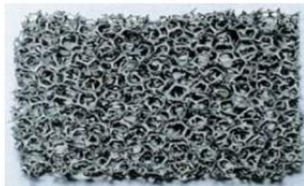
Figura 2.2 – Exemplo de uma espuma metálica de estrutura celular aberta [7]
