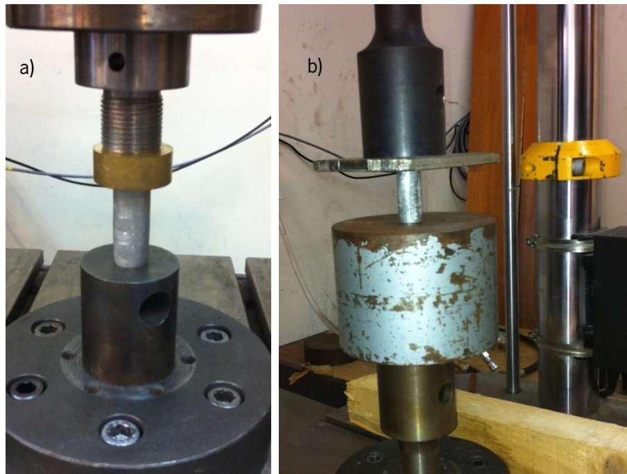
Figura 3.21 – Disposição das espumas no ensaio à compressão: a) Uniforme e b) Dual-size
