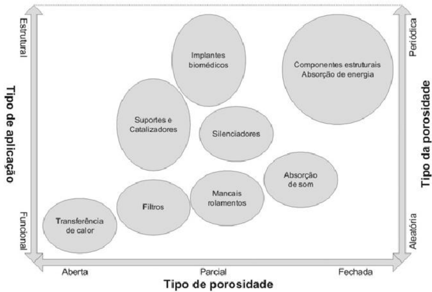
Figura 2.21 – Relação entre o tipo de porosidade da espuma e o tipo de aplicação [6]
