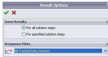
Figura A.23 – Ativação da opção da análise dos resultados em todos os passos
