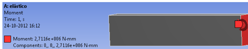
Figura 4.20 – Aplicação do momento fletor de 24 000 lbf.in na viga
