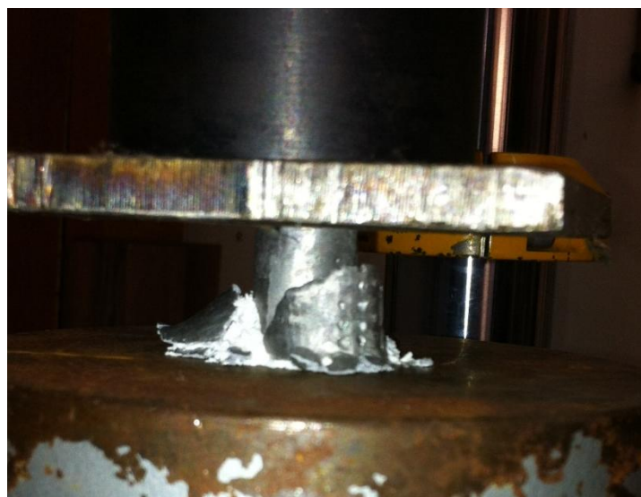
Figura 3.24 – Estado final da espuma dual-size no ensaio de compressão
