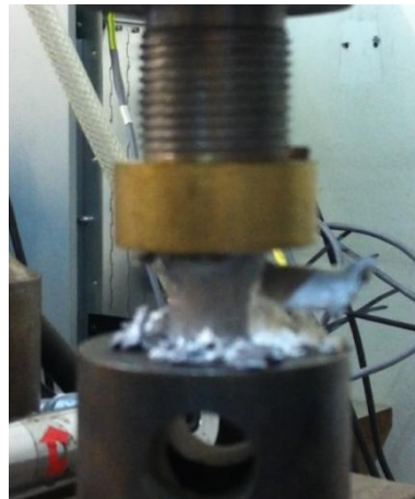
Figura 3.22 – Estado final da espuma uniforme no ensaio de compressão
