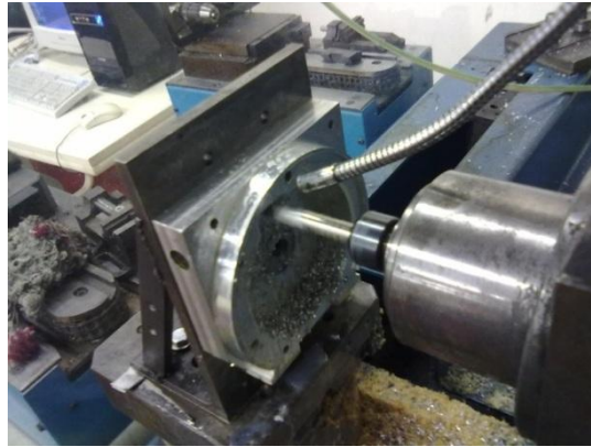
Figura 3.7 - Processo de maquinagem das cavidades destinadas a alojar o óleo de lubrificação
