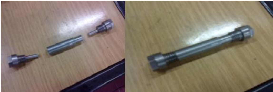
Figura 5.17 – Sistema alternativo de veio de balanceiros. À esquerda com os componentes separados e à direita com os componentes juntos
