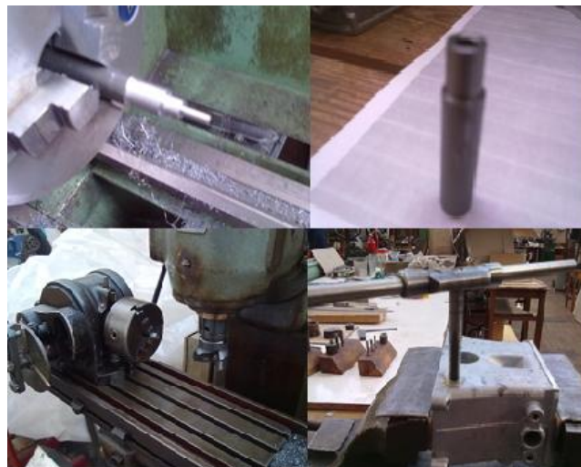
Figura 5.16 – Fases de fabrico do sistema alternativo do veio de balanceiros
