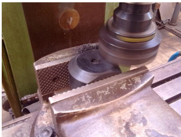
Figura 7.5 – Fase final do fabrico da parte inferior do coletor de admissão
