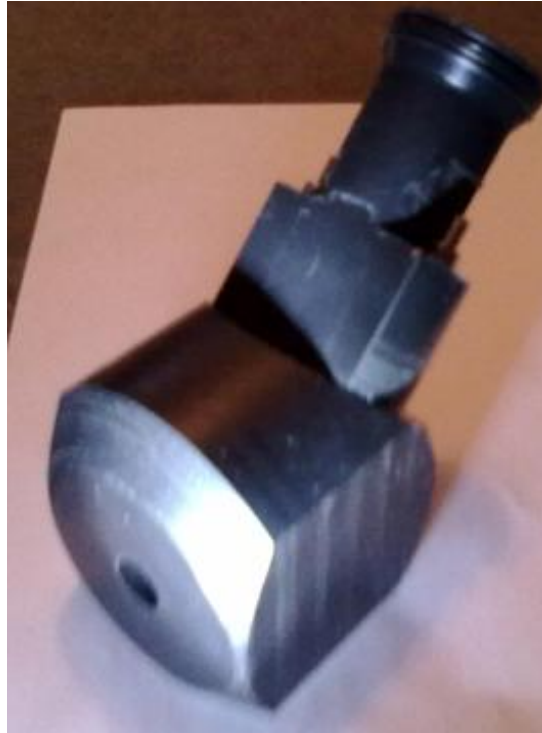
Figura 7.10 – Coletor de admissão montado
