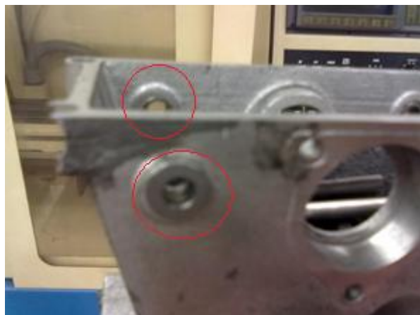
Figura 5.18 – Furos de 6 mm realizados na culassa
