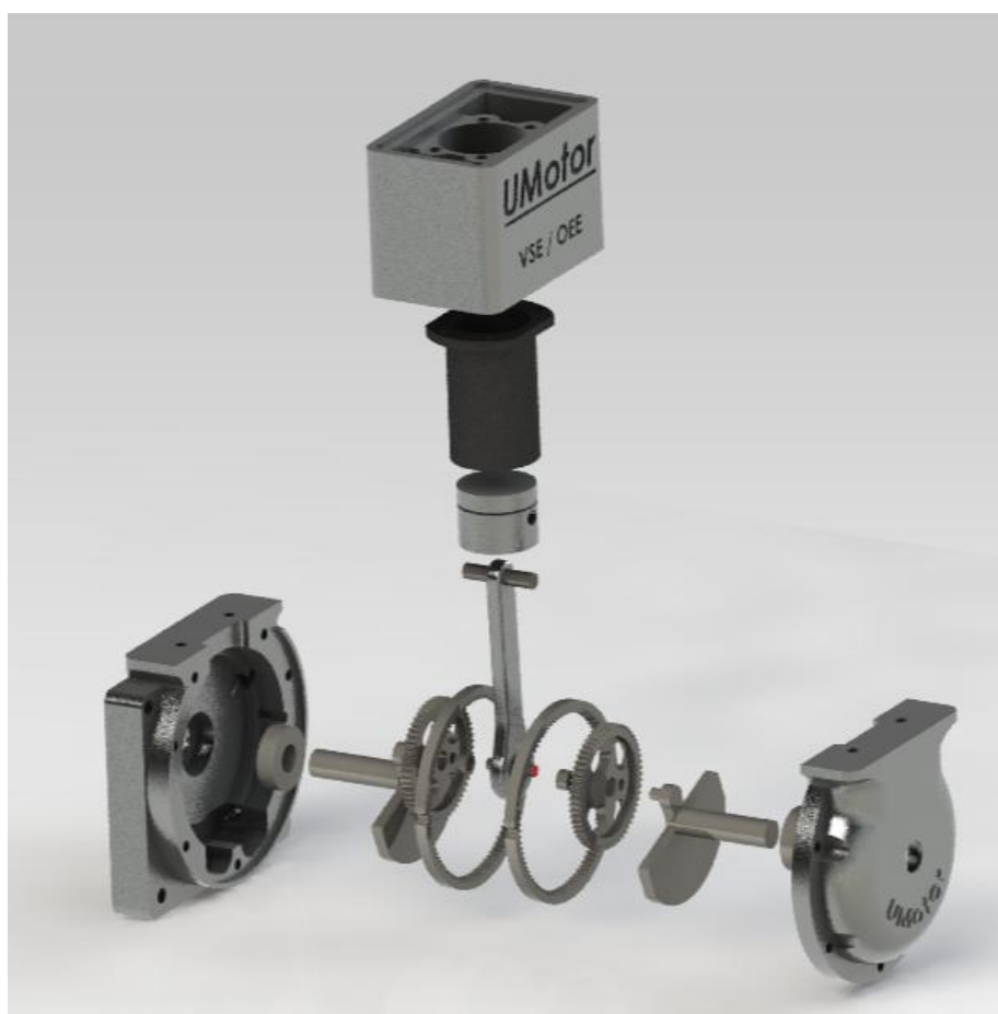
Figura E.1 – Representação da montagem do cárter e cilindro do UMotor
