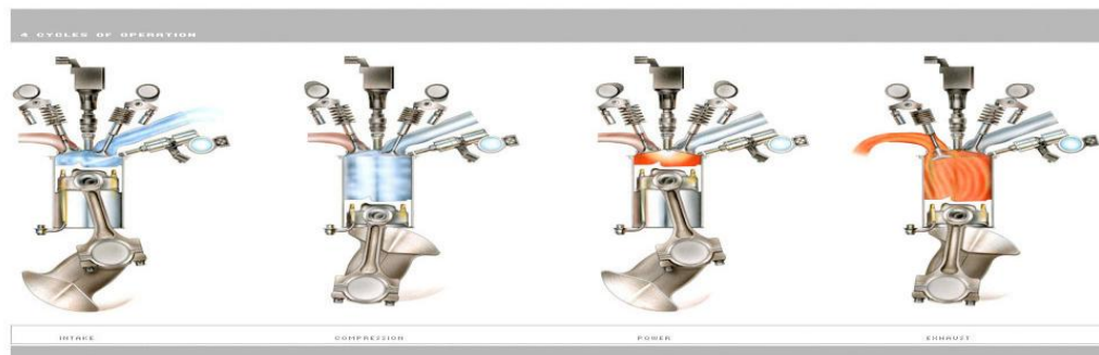
Figura 2.4 - Representação esquemática dos quatro tempos de funcionamento do motor KJ-ZEM-V6 [2]
