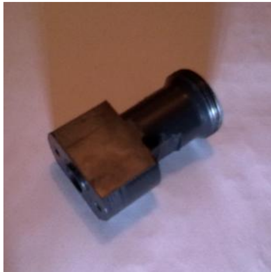
Figura 7.9 – Parte superior do coletor de admissão, já concluída
