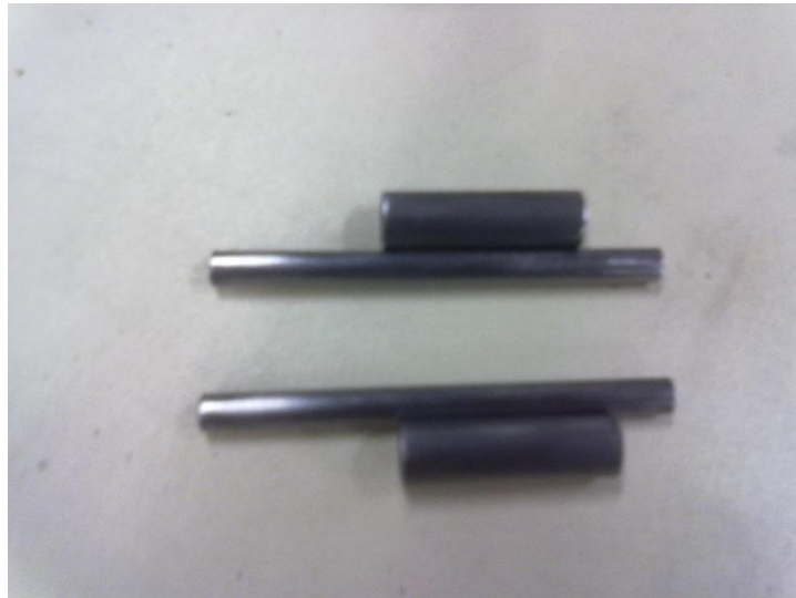
Figura 5.19 – Veios e casquilhos de preenchimento já acabados
