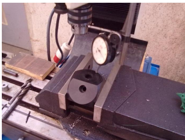
Figura 7.6 – Verificação do paralelismo por intermédio do comparador na face a furar
