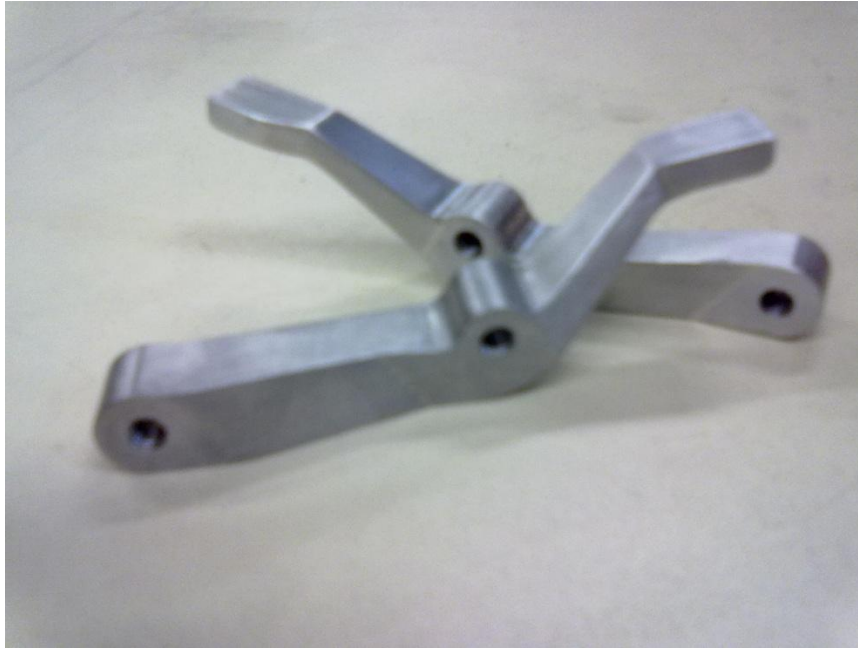
Figura 5.14 – Balanceiros já com a geometria final maquinada
