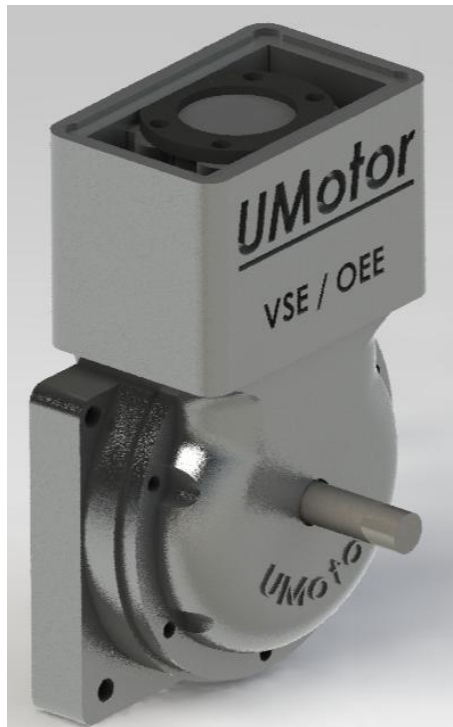
Figura E.2 – Representação do cárter e cilindro do UMotor montados
