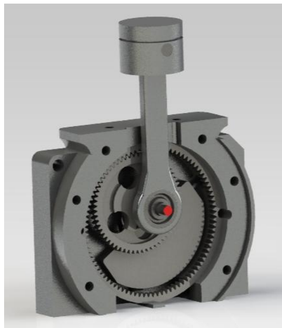
Figura 6.6 – Representação em corte do trem hipocicloidal montado no cárter
