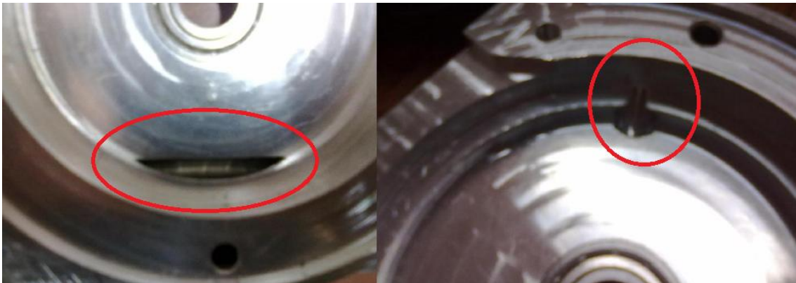
Figura 3.2 - Vista das condutas de extração e admissão do óleo de lubrificação, respetivamente
