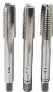
Figura 3.3 - Machos idênticos aos utilizados para abertura de rosca nas condutas do cárter
