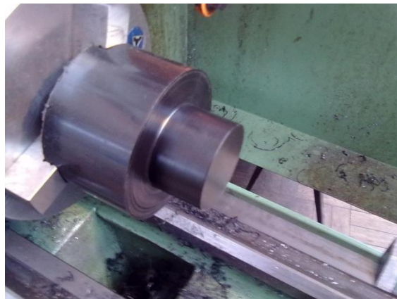
Figura 7.8 – Parte superior do coletor de admissão fixa no torno durante a fase de fabrico
