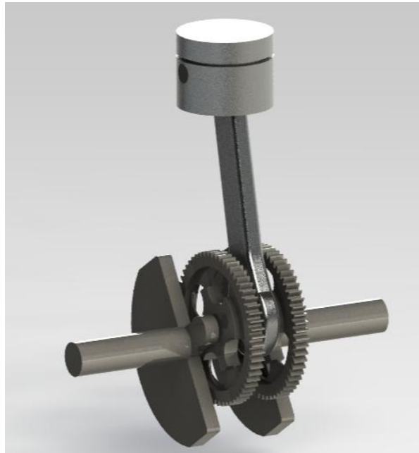
Figura 6.5 – Representação tridimensional do trem hipocicloidal montando a cambota escolhida
