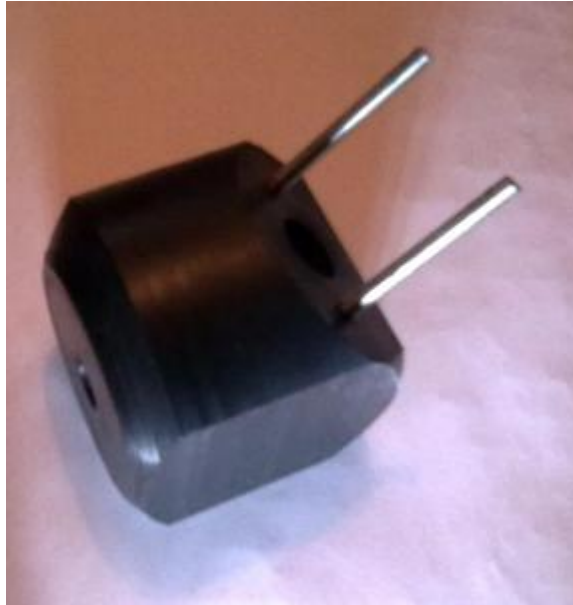
Figura 7.7 – Parte inferior do coletor de admissão já concluída
