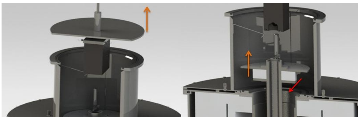
Figura 23 – Visualização de sentido abertura de tampa de câmara de vazamento
