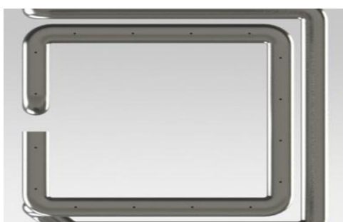
Figura 48 – Representação dos orifícios de insuflação do gás de protecção
