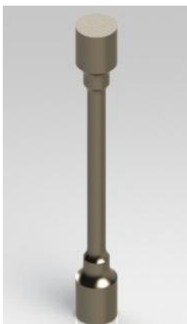
Figura 43 – Representação de provete de Mg
