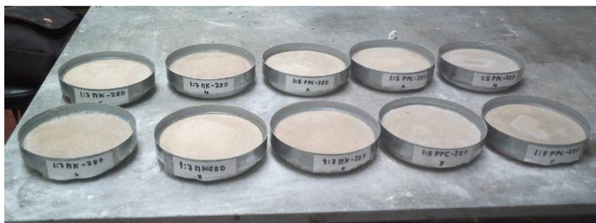
Figura 1 - Copos de ensaio no final do ensaio de permeabilidade ao vapor de água
