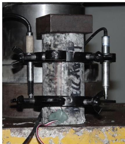
Figura 2 – Ensaio de provetes de granito
