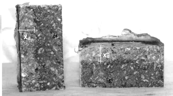
(b) frente de penetração de cloretos
