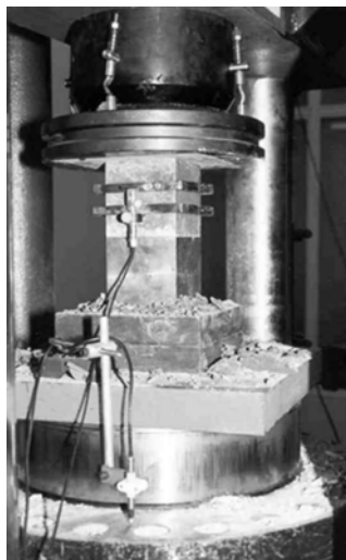
Figura 2 – Ensaio de compressão uniaxial de provetes cúbicos
