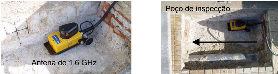
Figura 12. Inspeção para determinar a localização de barras pré-esforçadas embebidas no tabuleiro. Detalhe dos poços de inspeção realizadas uniformemente espaçados no passeio.
