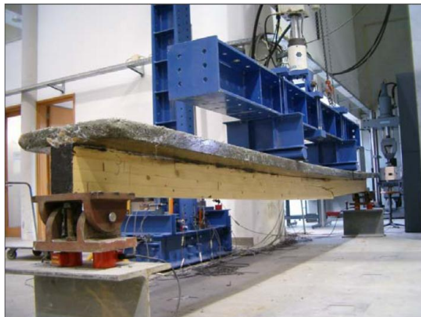
Figura 3 – Ensaio de vigas mistas madeira-betão leve [20]
