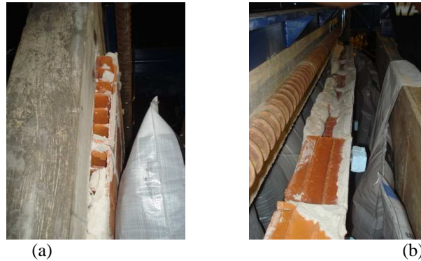
Figura 8 : Movimento da parede para fora do plano entre o pilar e a parede: (a) Fase intermédia do ensaio; (b) Separação completa do painel de alvenaria do pórtico de betão armado.
