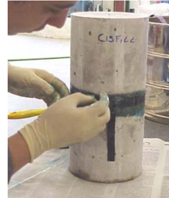
Figura 6 – Aplicação das faixas de manta.
