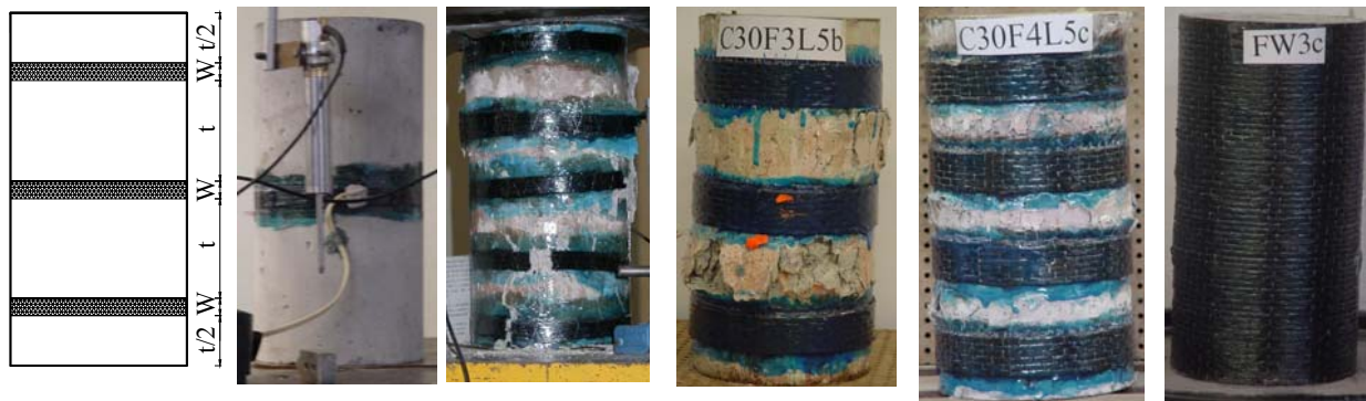
Figura 1 - Esquema de confinamento e fotos de alguns dos sistemas de confinamento adoptados
