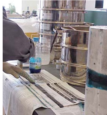
Figura 5 – Aplicação da resina nas faixas de manta.
