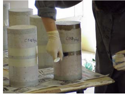
Figura 3 – Aplicação do primário nas zonas de fixação das faixas.
