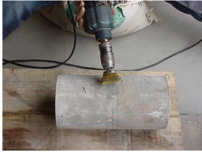
Figura 2 – Esmerilamento do provete nas zonas de fixação das faixas.
