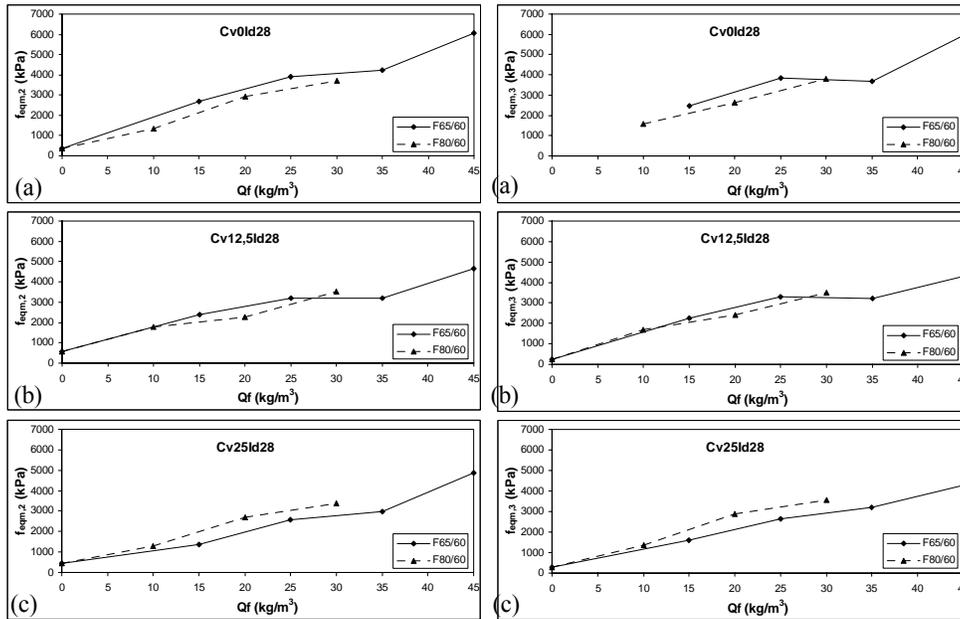
Figura 8 –  $f_{eq,2}$  versus quantidade de fibras em provetes com 0% (a), 12.5% (b) e 25% (c) de Cv.
