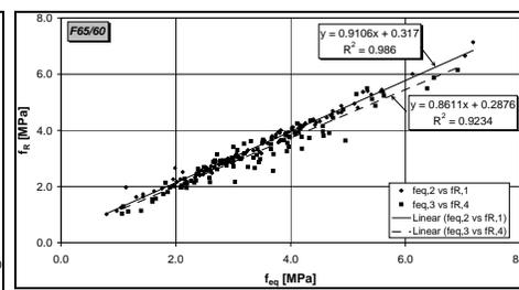
Figura 19 – Correlação entre  $f_{eq}$  e  $f_R$  nas fibras F65/60.
