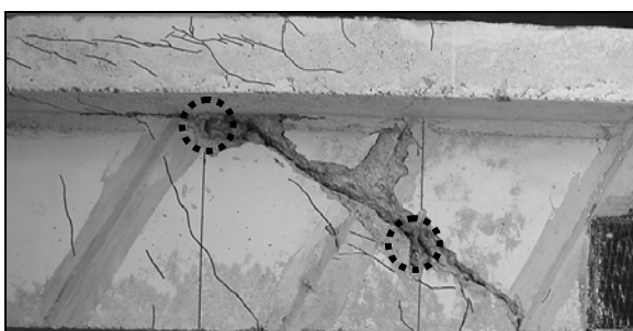
h) Identificação dos estribos e análise pormenorizada da zona da fenda de rotura de corte (ambas as faces)
