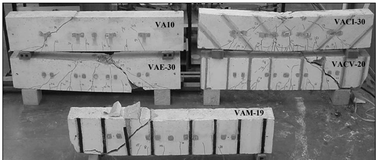
Figura 7 - Modos de rotura verificados nas vigas da série A com 4\phi 10 .
