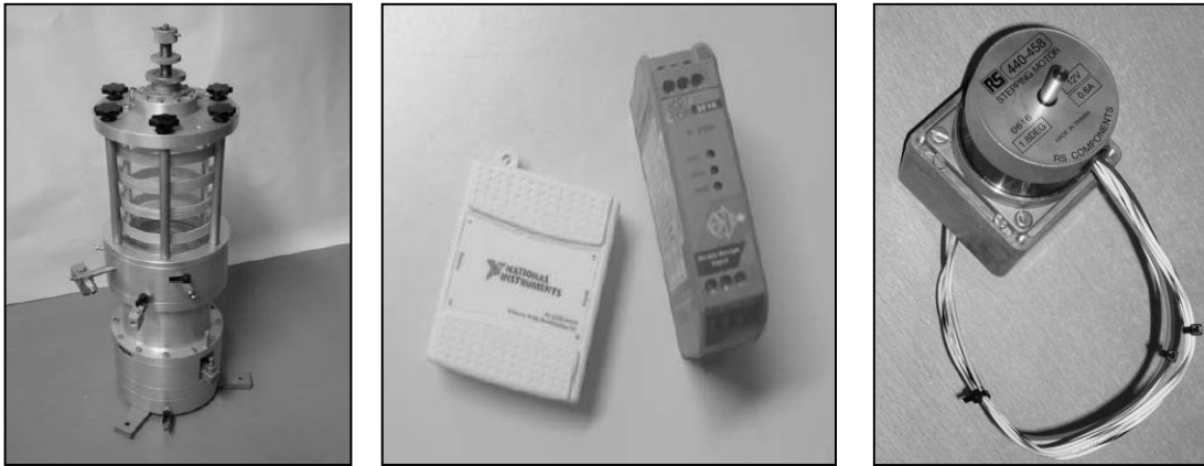
Figura 3 - (a) Câmara triaxial com actuador pneumáticos incorporado, (b) componentes do sistema de aquisição e (c) motor DC de passo
