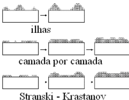
Figura 1.5 – Mecanismos básicos de crescimento de filmes finos.
