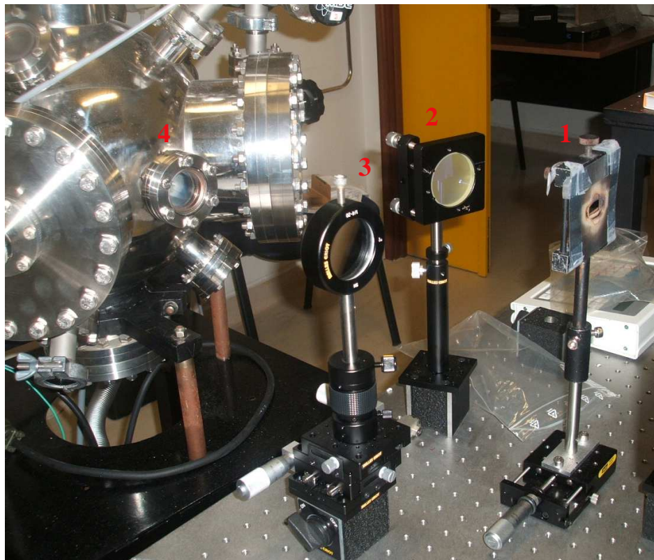
Figura 1.7 – Elementos ópticos entre a porta de saída do feixe do laser e a entrada na câmara de deposição. 1 – Abertura; 2 – espelho; 3 – lente convergente; 4 – porta de entrada do feixe de laser na câmara de deposição.
