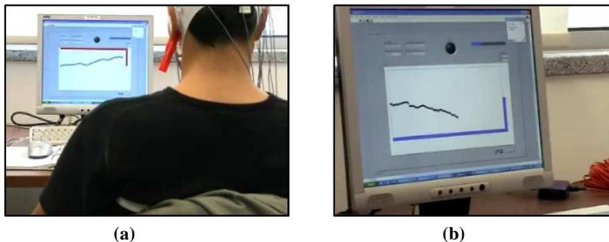
**Figura 1.9 – Interface cérebro-máquina aplicada ao controlo do cursor: (a) resposta à imaginação do movimento das mãos; (b) resposta à ausência de imaginação motora (i.e. relaxamento).**
