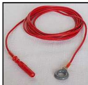
Figura 1.6. Eléctrodo convencional fabricado em Ag/AgCl para aquisição de electroencefalograma.
