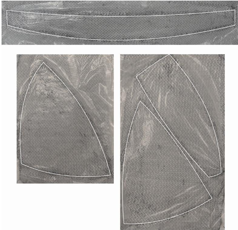
Fig. 4.34 - Colagem dos moldes de SMA de tear rectilíneo à membrana (Foto da autora)
