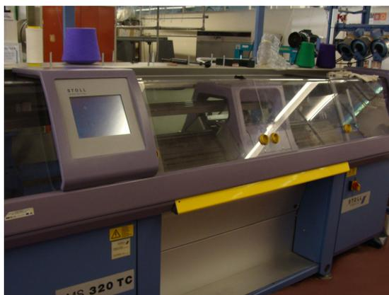
Fig. 4.24 - Desenvolvimento em tear rectilíneo electrónico STOLL (Foto da autora)
