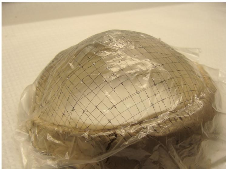
Fig. 4.32 - Prototipagem em tela com a membrana aplicada (Foto da autora)
