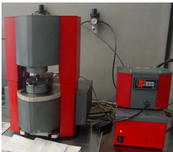
Figura 5.4 – Reómetro Reologica StressTech HR utilizado na investigação
