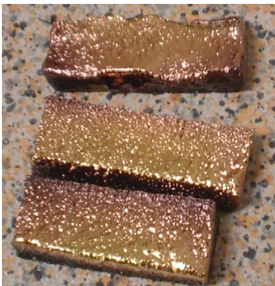
Figura 6.15 – Amostras de betume-borracha preparadas para o MEV
