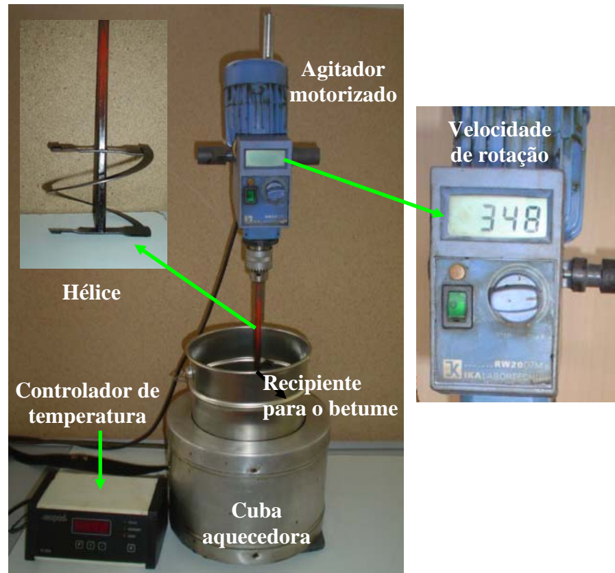
Figura 6.1 – Agitador utilizado para produção do betume-borracha tipo continuous blend
