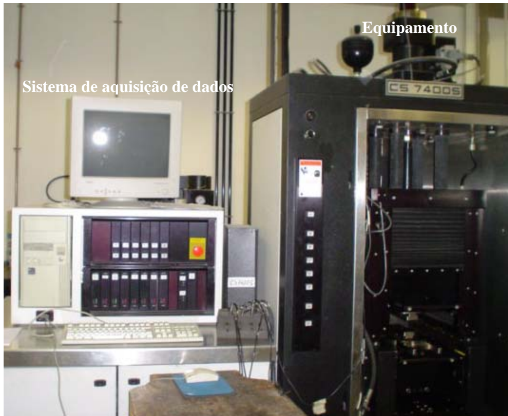
Figura 6.53 – Equipamento para execução do ensaio RSST-CH (modelo CS 75005)
