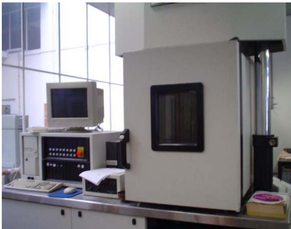
Figura 6.25 – Equipamento servo-hidráulico para a realização dos ensaios de flexão alternada (modelo CS 7800)
