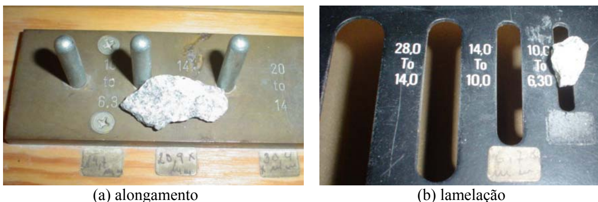
Figura 3.1 – Dispositivos de medição do índice de forma (BS 812, 1990)
