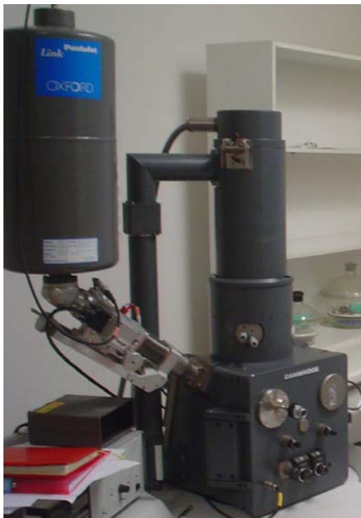
Figura 6.14 – Microscópio Electrónico de Varrimento (MEV)
