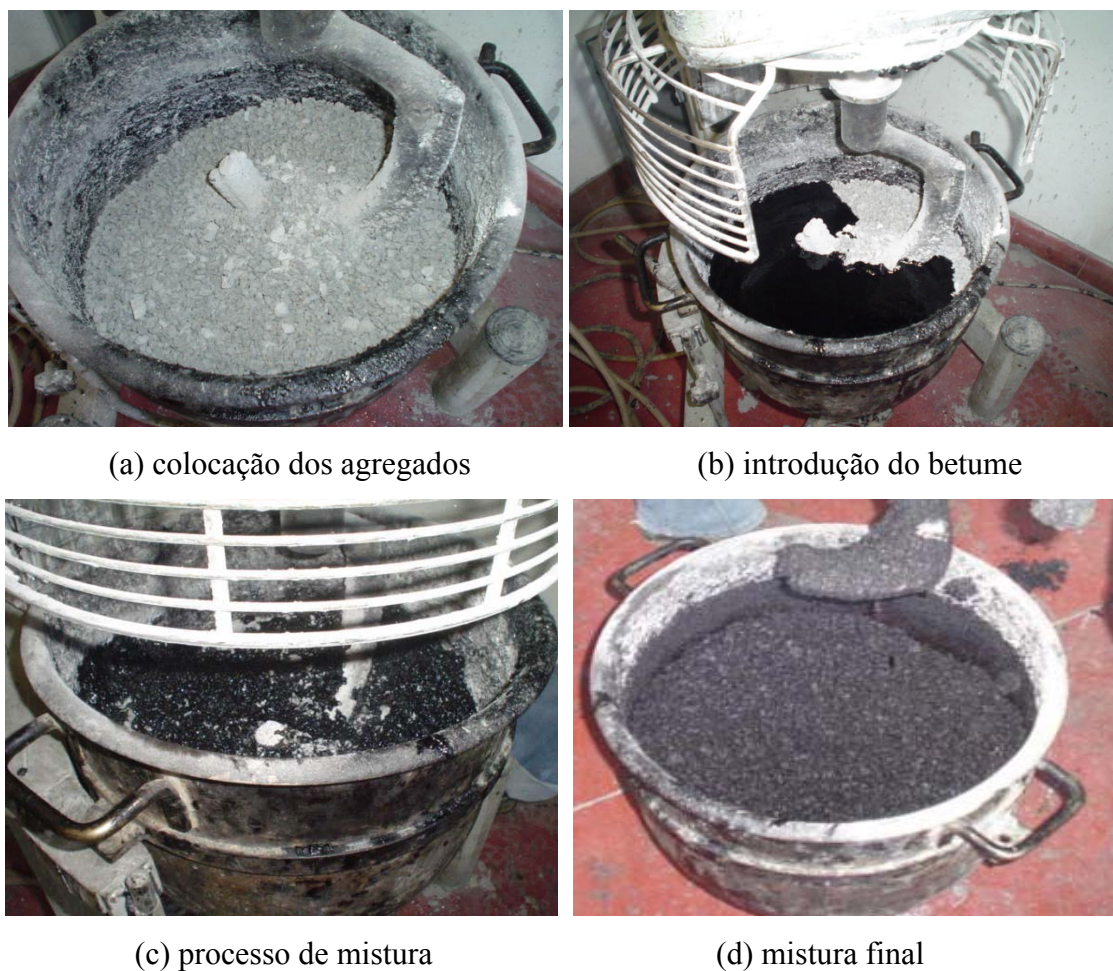
Figura 6.19 – Homogeneização dos materiais
