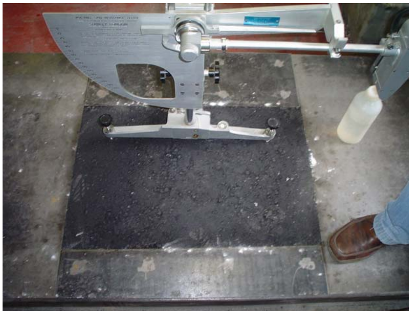
Figura 6.127 – Pêndulo britânico utilizado no estudo
