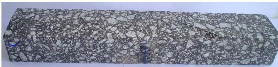
Figura 6.23 – Provete prismático (viga) para ensaios de fadiga e de módulo dinâmico
