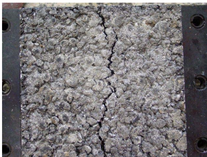
Figura 8.17 – Exemplo de uma fenda produzida no provete após ensaio (vista superior)
