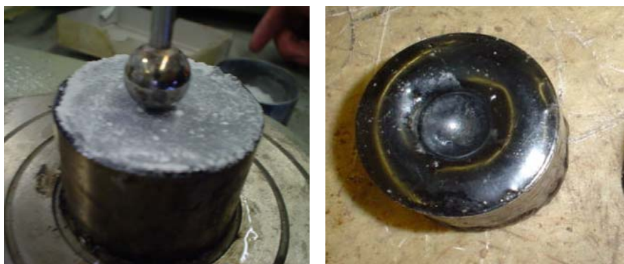
Figura 5.3 – Provete no ensaio de resiliência
