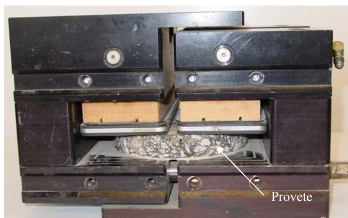
Figura 8.13 – Dispositivo de reflexão de fendas montado com provete
