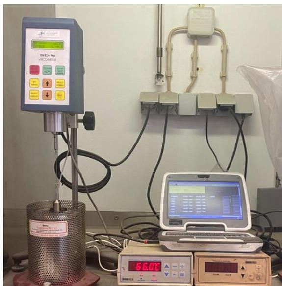
Figura 18 - Viscosímetro rotacional
