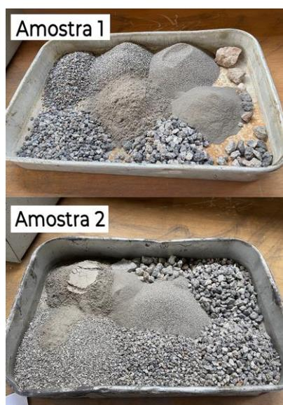
Figura 14 - Amostras após ensaio de teor de betume e ensaio de granulometria
