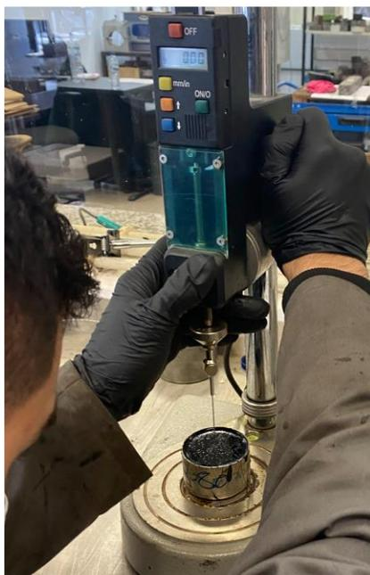
Figura 17 - Aparelho utilizado para realização do ensaio de penetração
