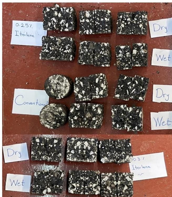
Figura 29 - Provetes utilizados no ensaio de sensibilidade à água
