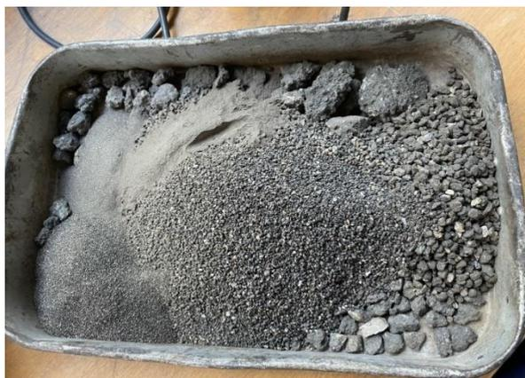
Figura 13 - RAP após ensaio de granulometria
