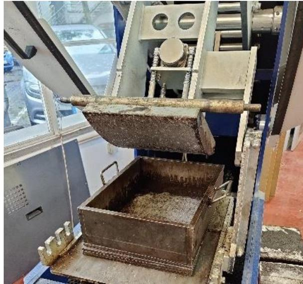
Figura 20 - Equipamentos de compactação de lajetas de mistura betuminosa
