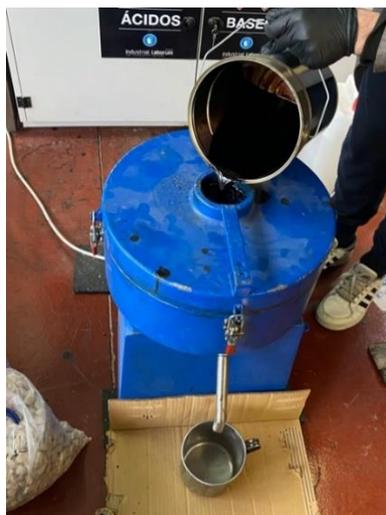
Figura 9 - Centrifugadora Rotarex.
