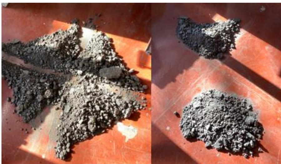
Figura 8 - Seleção da amostra representativa do material fresado.
