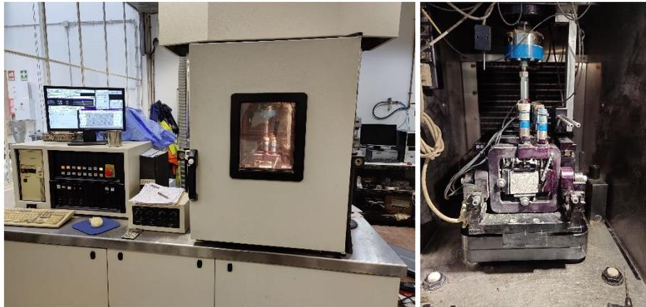
Figura 23 - Equipamento servo-hidráulico utilizado nos ensaios de flexão a 4 pontos
