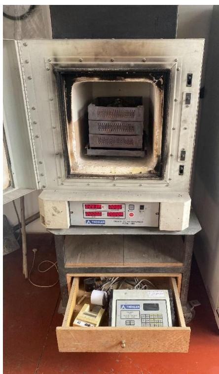
Figura 15 - Mufla utilizada para determinação da percentagem de betume
