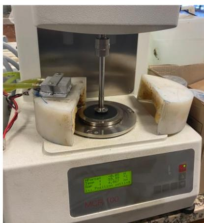
Figura 19 - Reómetro dinâmico de corte
