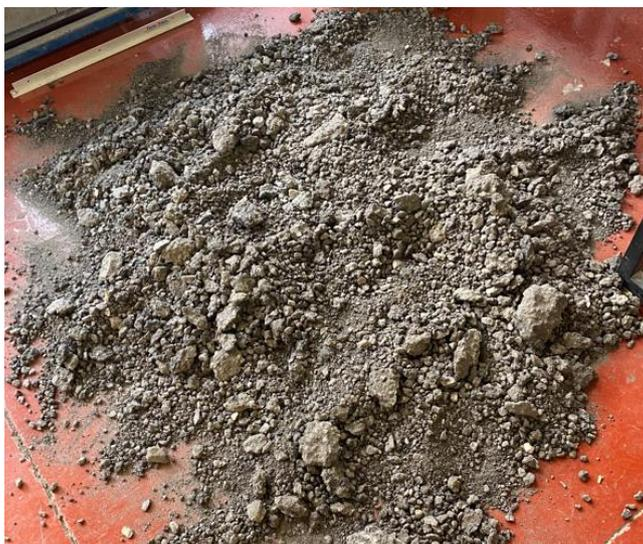
Figura 7 - Amostra do material fresado
