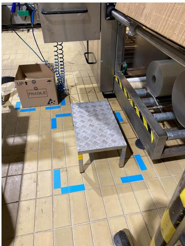
**Figura A3** - Banco auxiliar para colocação do cartão na *Condi*.
