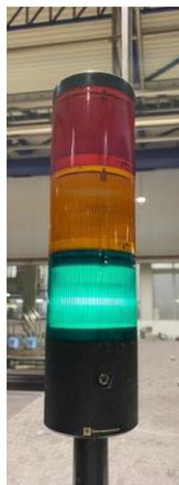
**Figura 15** - Ferramenta *Andon* aplicada nas instalações da empresa Lactogal
