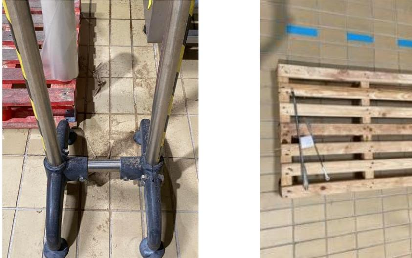
**Figura 30** - Imagem da aplicação do 1ºS: eliminação de material desnecessário na linha. Imagem à esquerda, eliminação das aparas de cartão e na imagem à direita eliminação de um utensílio de limpeza e de um outro utensílio pertencente a outra linha de distribuição.
