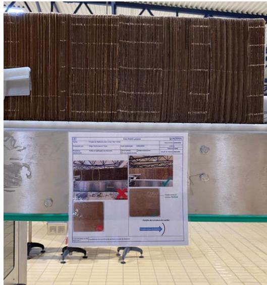
**Figura 24** - OPL implementada junto ao posto de trabalho relativamente à correta colocação do intercalar no equipamento.
