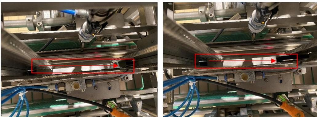
**Figura 27** - Ação de melhoria (redução do comprimento da gaveta) realizada na gaveta da linha de distribuição nº 6 (antes da ação - imagem à esquerda; Depois da ação - imagem à direita).
