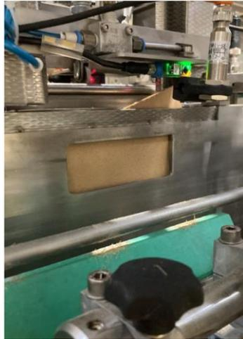
**Figura 26** - Imagem ilustrativa do problema de falha na aplicação do intercalar. A gaveta fecha em cima do cartão.
