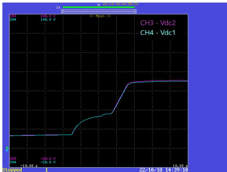
Figure 6.6: Carregamento e regulação do barramento CC.
