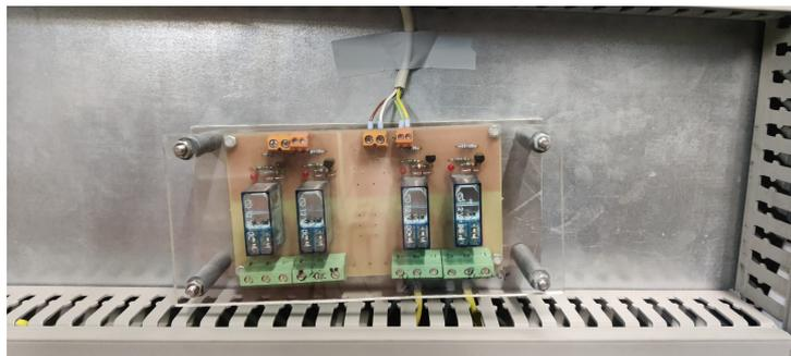
**Figure 5.9:** Placa de relés para atuação dos contactores.
