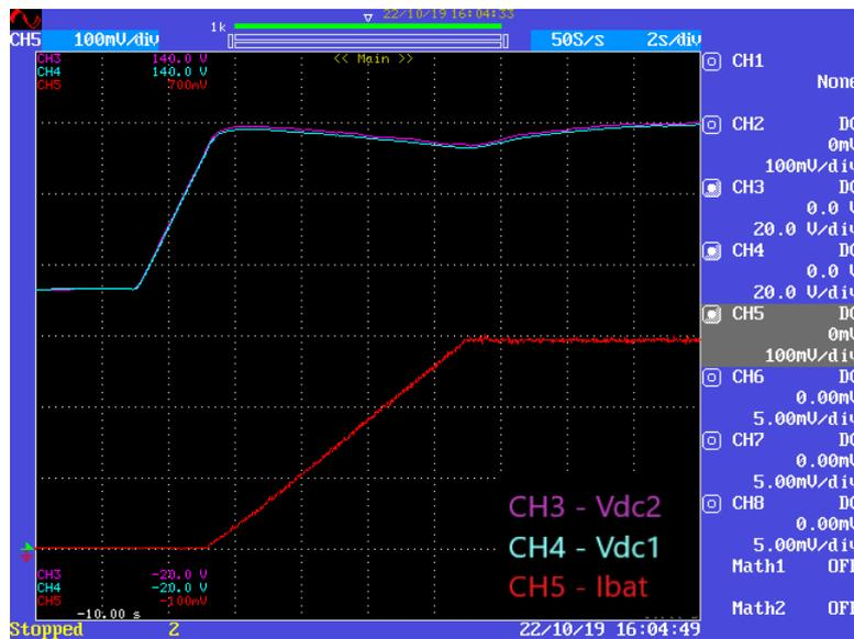
**Figure 6.9:** Extração de energia das baterias com rampa de referência.
