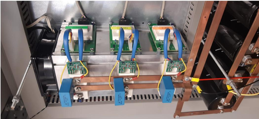
**Figure 5.11:** Circuitos de *drive* dos IGBT montados no dissipador.
