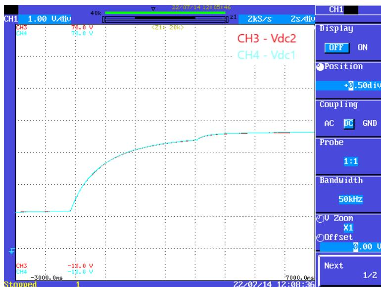
Figure 6.5: Pré-carga automática do barramento CC
