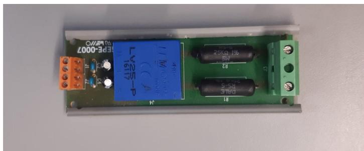
**Figure 5.3:** Sensor de tensão CYHVS5-25A.
