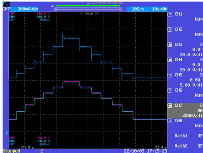
Figure 5.6: Barramento CC com o conversor no modo boost .
