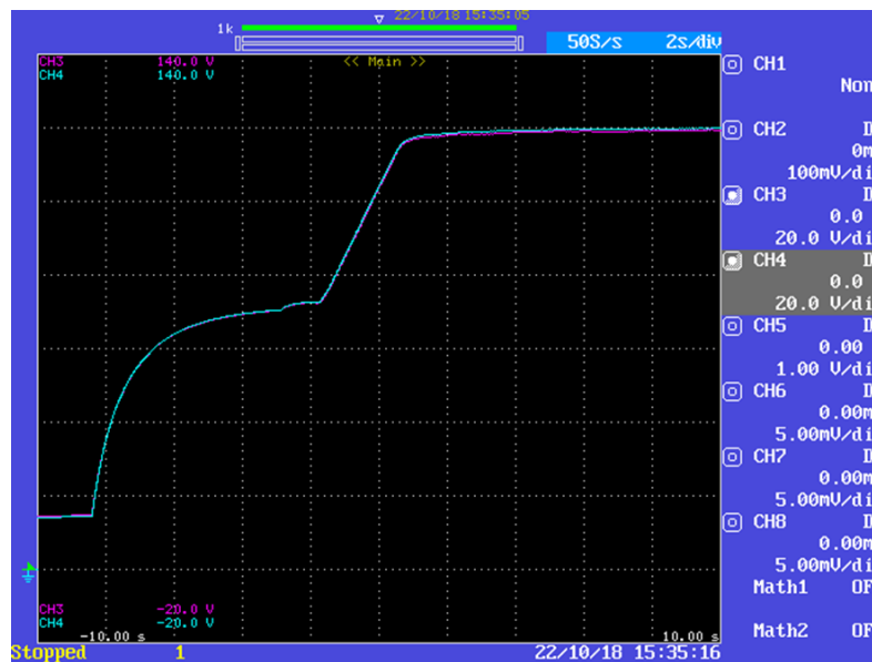
Figure 5.8: Pré-carga e regulação do barramento CC.
