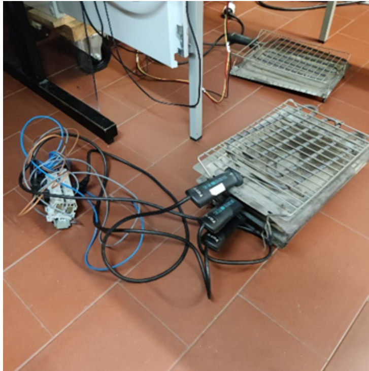
Figure 5.5: 3 grelhadores ligados em série ( R_{\text{carga}} = 78 \Omega ).
