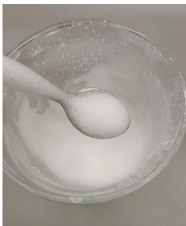
Figura 73 – Fotografia da formulação de base aquosa de 60 g/L de partículas de etilcelulose juntamente com 10 g/L de Eco-DLS e Poloxamer 188 a 2%, preparada para a funcionalização de têxteis.
