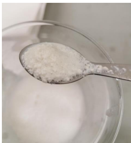
Figura 71 – Fotografia da formulação de base aquosa de 60 g/L de partículas de etilcelulose juntamente com 10 g/L de Impranil Eco-DLS, preparada para a funcionalização de têxteis.
