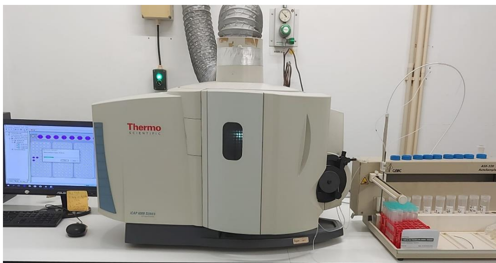
Figura 19 - Espectrofotómetro de emissão ótica com plasma indutivo acoplado utilizado como método de quantificação dos analitos em estudo.
