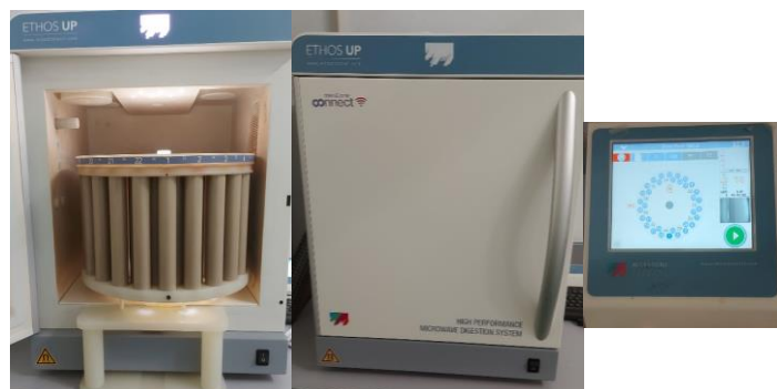
Figura 17 - Digestor micro-ondas utilizada para a extração dos analitos em estudo
