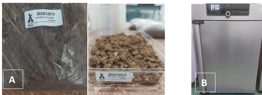
Figura 14 - Representação do processo de preparação das amostras de corretivos orgânicos. (A) amostra devidamente identificada; (B) Processo de secagem das amostras a 105°C;
