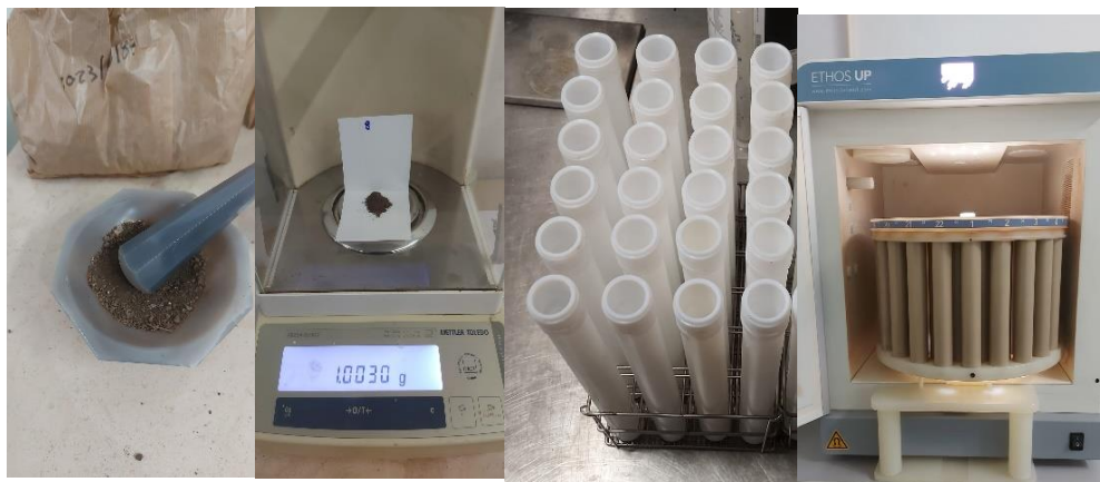
Figura 18 - Etapas do processo de extração dos metais pesados do solo.
