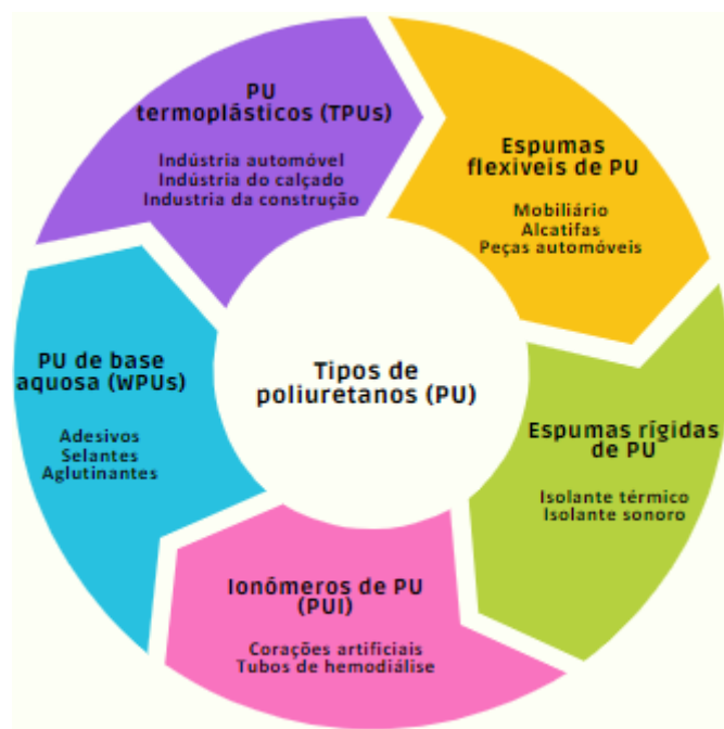
Figura 4. Esquema representativo dos tipos de poliuretanos (PUs) e algumas das suas aplicações baseado em [27].
