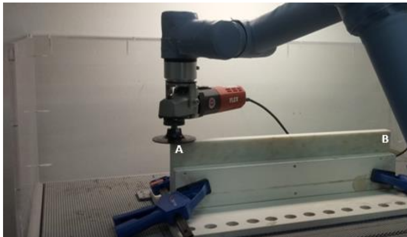
Figura 44. Representação do percurso realizado pelo braço robótico durante o teste.
