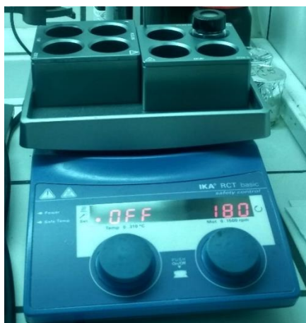
Figura 22. Placa térmica de agitação magnética utilizada na preparação das soluções poliméricas com dipéptidos.
