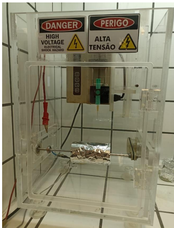
Figura 23. Montagem experimental do electrospinning, usado para a produção de nanofibras.
