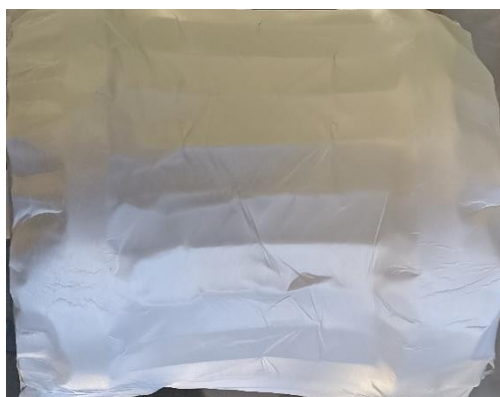
Figura 24. tapete de micro/nanofibras poliméricas com dipéptido incorporado produzido por electrospinning.
