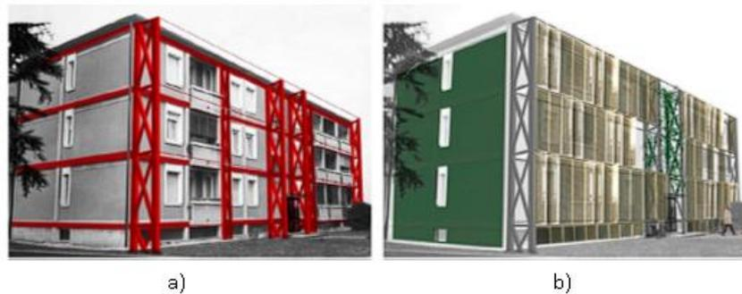
Figura 14 - Aplicação de um sistema de exosqueleto de aço para reabilitação sísmica integrada e eficiência energética de edifícios: a) estrutura externa para reforço sísmico; b) sistemas de fachada para eficiência energética e renovação estética (Ademovic et al., 2022).
