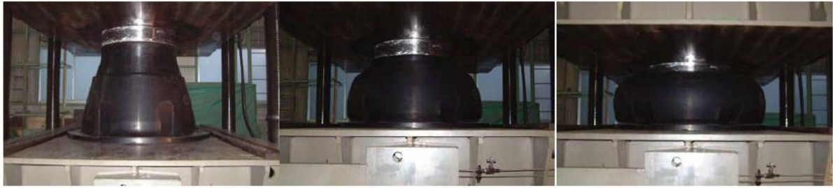
Figura 43 - Processo laboratorial para determinação do rendimento da defesa (ShibataFenderTeam, 2015).
