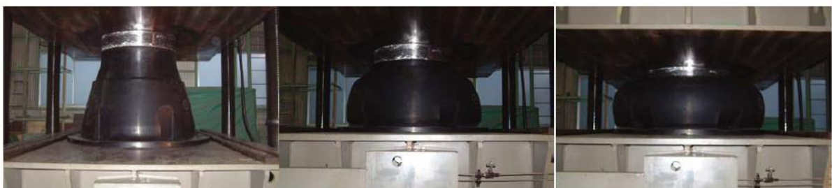
Figura 61 - Deformada da defesa marítima durante ensaios laboratoriais (ShibataFenderTeam, 2015).
