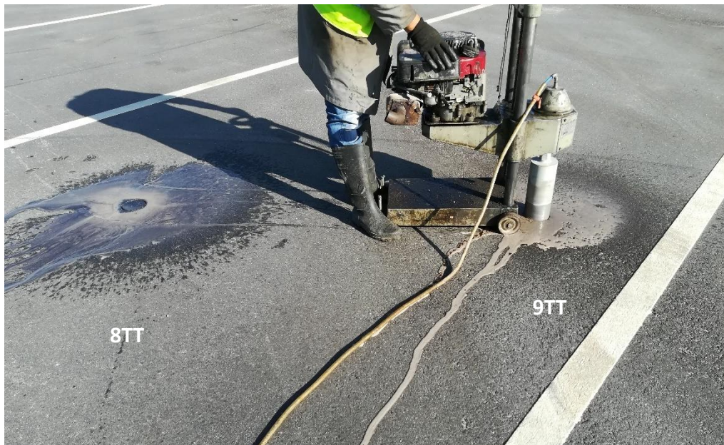
Figura 12 – Fase de extração de um carote (9) da zona 1 do pavimento na plataforma
