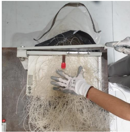
Figura 12 – Redução de dimensão com recurso a guilhotina manual
