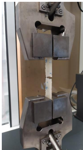
Figura 39 – Ensaio de tração soldadura 2 lados
