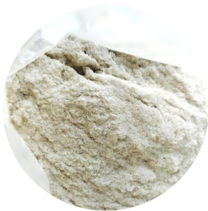
Figura 28 – Pó removido do material triturado após peneiração
