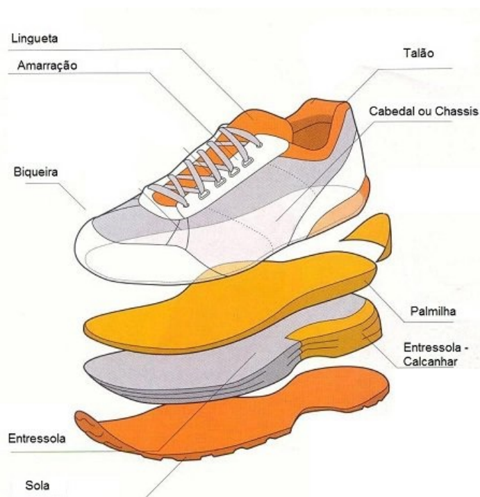
Figura 2.1: Representação esquemática dos componentes de um sapato [34].
