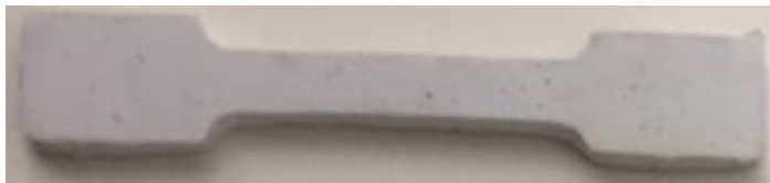
Figura 4.7: Proвете para ensaio de tração a borracha SBR.
