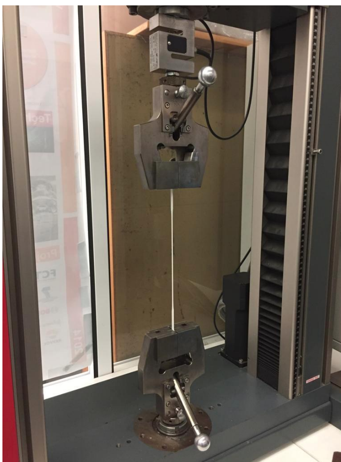
Figura 4.8: Máquina de ensaio utilizada para medir módulo de elasticidade de borracha SBR.
