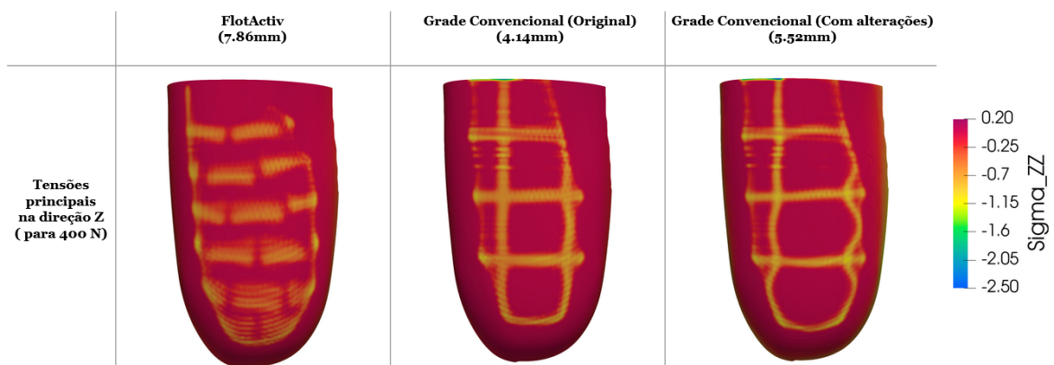
Figura 5.9: Tensões de von Mises para 400N nas três solas.
