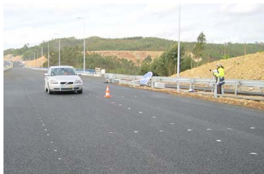
Figura 2.26 – Método Coast-By (CB)
