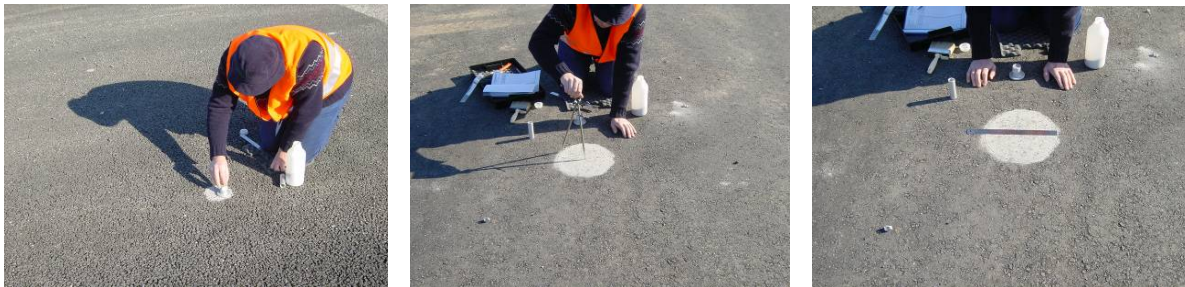
Figura 7.9 – Ensaio da mancha de areia
