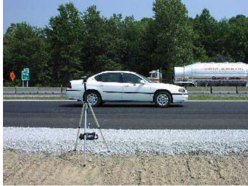
Figura 2.23 – Método estatístico de passagem (SPB) [Hanson et al., 2005]
