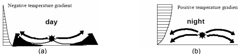
Figura 3.13 – Refracção da onda sonora devido ao gradiente da temperatura [Watts, 2005]
