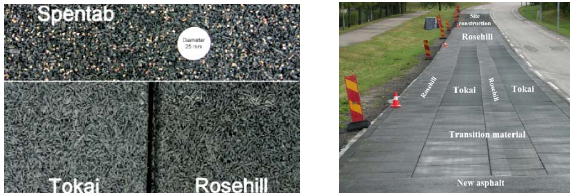
Figura 4.15 – Superfícies de estrada poro-elásticas em Estocolmo, Suécia [Sandberg e Kalman, 2005].
