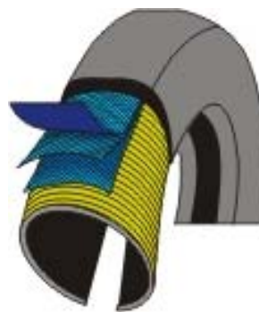
Figura 6.5 – Pneu Radial [www.braziltires.com]
