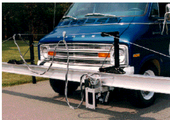
Figura 5.6 – Perfilómetro a laser ROSANvm [Koklanaris, 1998]
