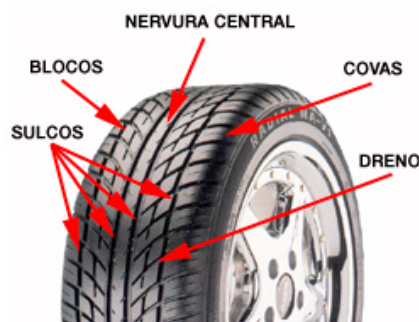
Figura 6.10 – Composição do piso de um pneu [www.braziltires.com.br]
