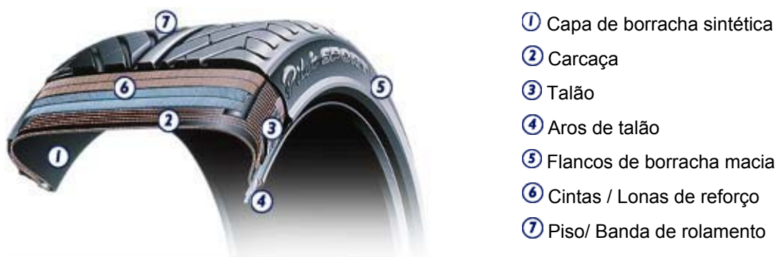
Figura 6.3 – Constituição de um pneu [www.michelintransport.com]
