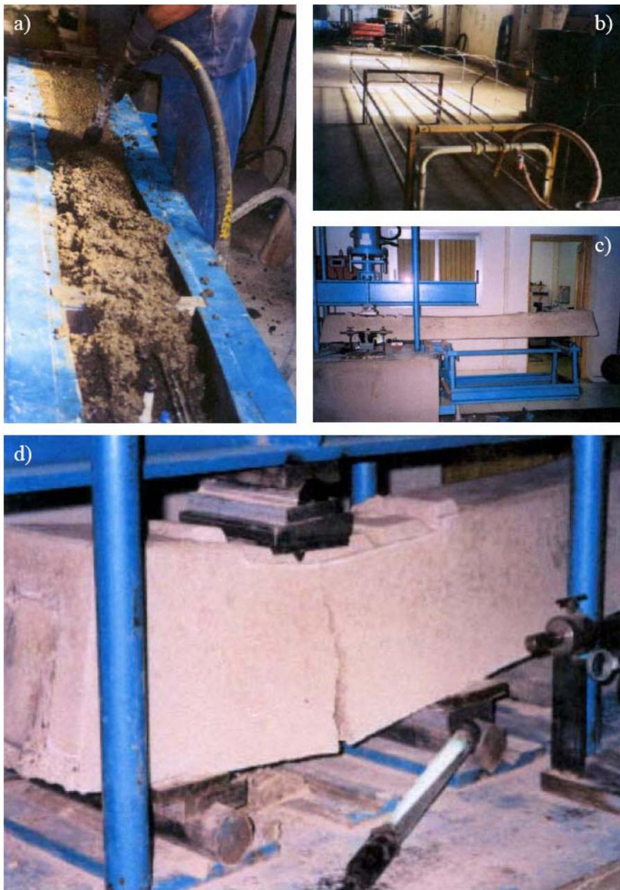
Figura 2 :Travessa para linha ferroviária em betão geopolimérico pré-fabricado à base de cinzas volantes: a) Betonagem e vibração; b) Dispositivo de cura com vapor de água; c) Ensaio de flexão; d) Pormenor da rotura em flexão [22]
