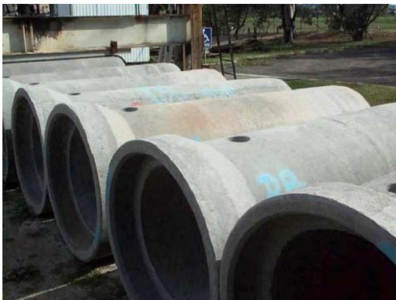
Figura 1 :Manilhas de 1500 mm de diâmetro para redes de águas residuais executadas em betão geopolimérico à base de cinzas volantes, escórias de alto forno e uma pequena percentagem de cimento portland [17]
