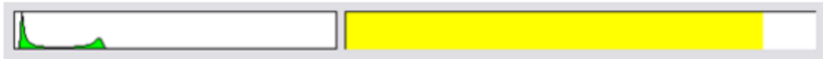
Figura 59 - Exemplificação de um histograma e uma barra de foco existente no software Vic-Snap para focagem da imagem.
