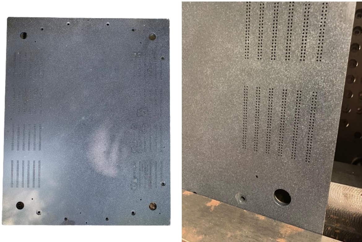
Figura 36 - Modelo físico da placa de cama de agulhas com o speckle utilizado na análise experimental.
