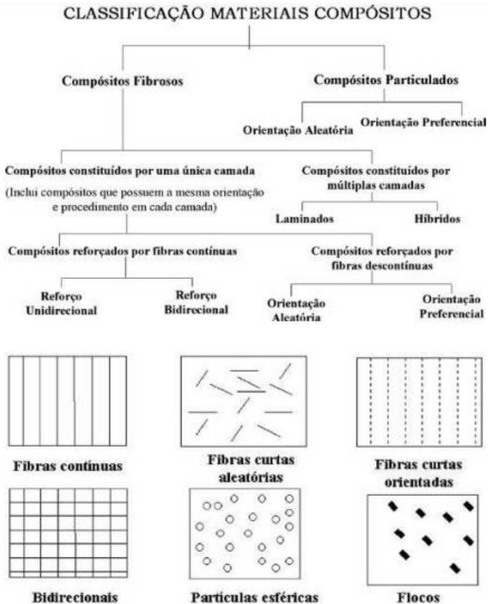
Figura 9 - Classificação dos materiais compósitos de acordo com o tipo de reforço utilizado (VENTURA, 2009, p. 13).
