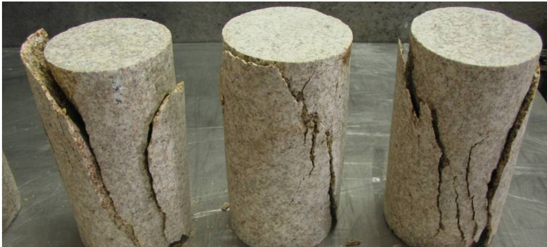
Figura 3.5 – Padrão de fendilhação na rotura dos provetes de granito.
