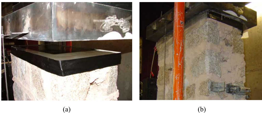
Figura 5.12 – Rectificação da face de topo das paredes: (a) argamassa auto-nivelante colocada no topo da parede; (b) ajuste da argamassa ao prato do topo.
