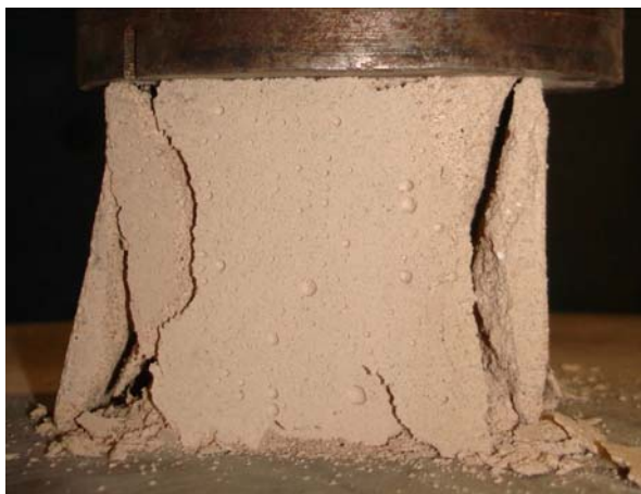
Figura 3.6 – Rotura típica de um provete de argamassa.
