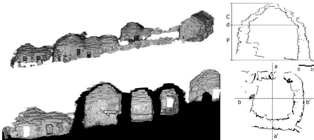
Figura 6: Imagens de análise e caracterização do grupo A, produzidas a partir da nuvem de pontos gerada por levantamento LIDAR [3, 5]. aa') eixo longitudinal; bb') eixo transversal; P) paredes; C) falsa cúpula; d) charneira entre P e C.
