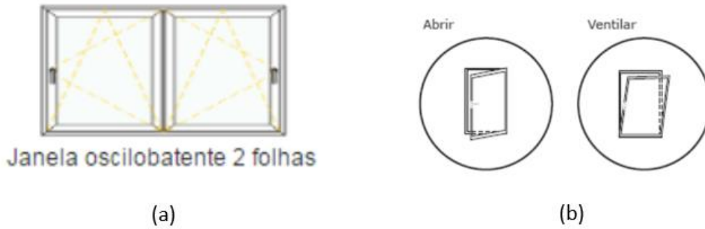
Figura 31 - (a) Representação esquemática de janelas oscilo-batente de 2 folhas (b) representação das aberturas
