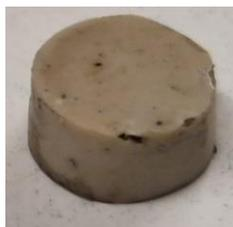
Figura 29- Amostra resultante da prensagem a quente.
