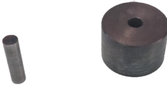
Figura 20- Molde e Punção utilizados na prensagem a quente.
