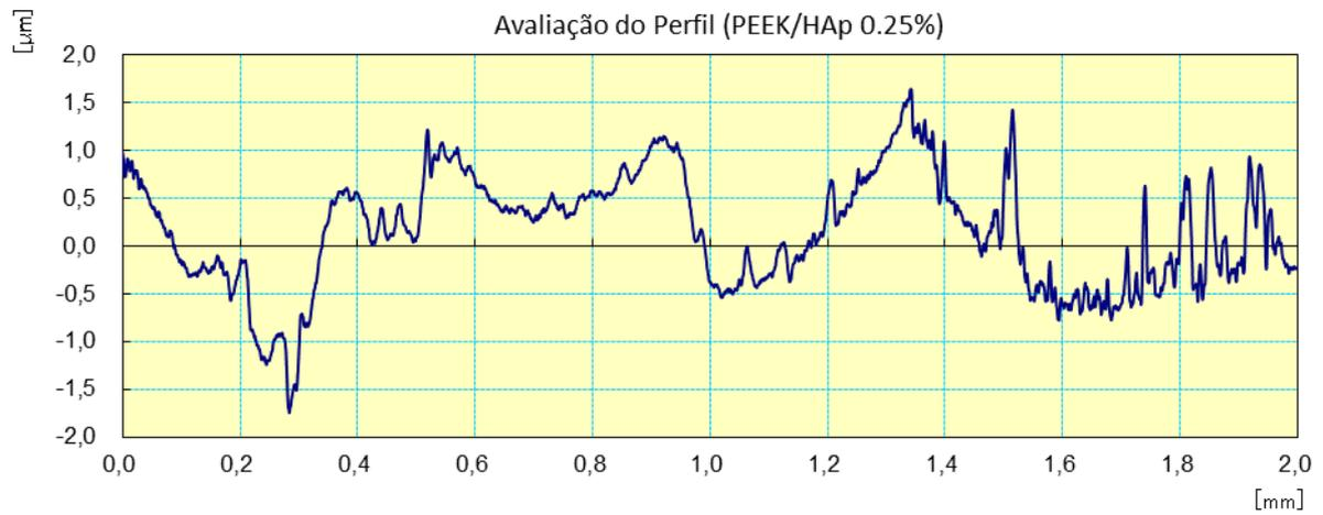
Figura 36- Perfis de rugosidade transversal 2D representativos da região processada da amostra de PEEK/HAp 0,25%.
