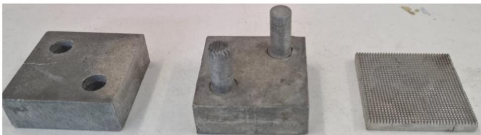
Figura 59- Matriz e punções utilizados na prensagem a quente.
