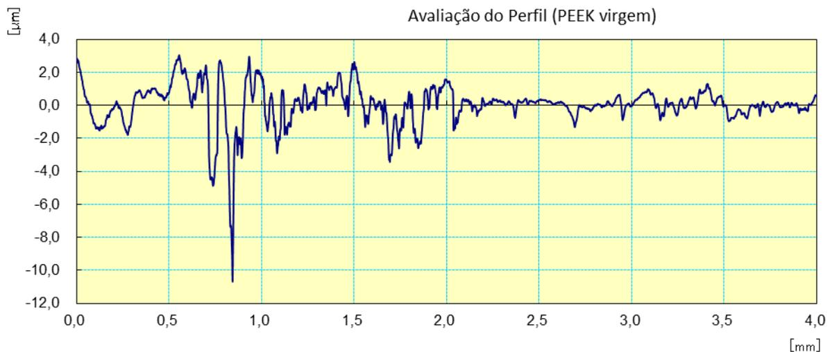
Figura 35- Perfis de rugosidade transversal 2D representativos da região processada da amostra de PEEK virgem.
