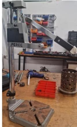
Figura 58- Alavanca manual utilizada na prensagem a quente.
