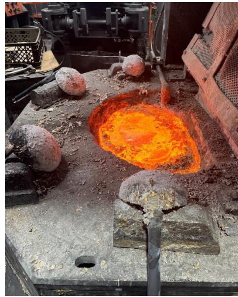
Figura 17 Transformação do metal sólido em líquido e colheres usadas para o vazamento
