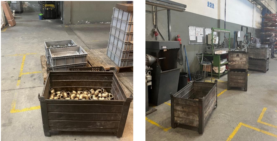
Figura 28 Falta de marcações/Marcações sem objetivo no shopfloor
