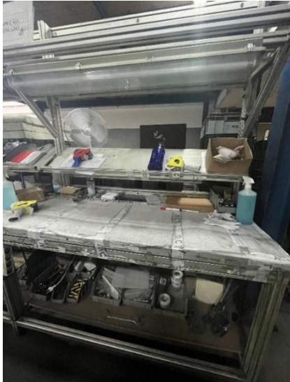
Figura 43 Luzes desfavoráveis e inexistência de tapete anti-fadiga
