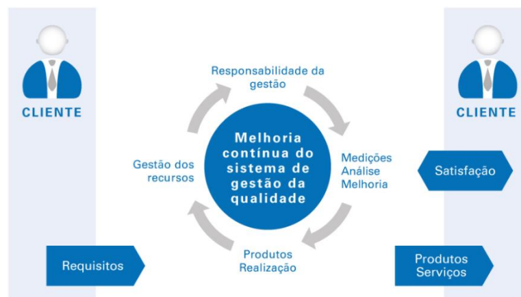
Figura 1 - Funcionamento da ISO 9001
