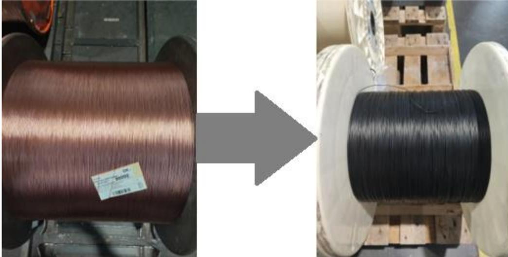
*Figura 9 – Bobine antes e depois do processo de extrusão*
