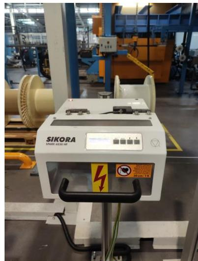
Figura 22 – Spark-Tester da linha 12
