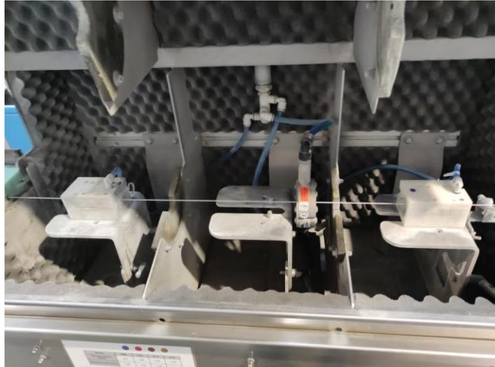
Figura 21 - Sopradores utilizados na linha 12
