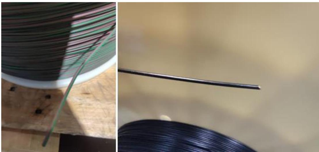
*Figura 27 - Fio com fillet (verde e vermelho) e sem fillet (preto)*
