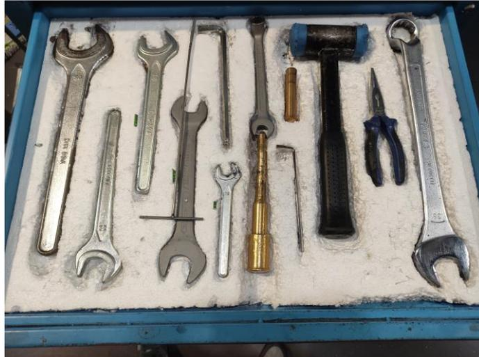
*Figura 42 – Painel de ferramentas depois de aplicar 5S*
