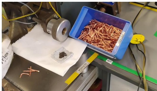
Figura 57 – Desperdício de pasta de solda
