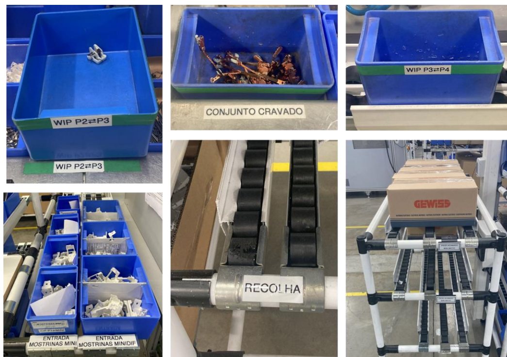
Figura 129 – Exemplos de gestão visual (WIP, entrada/saída de material, rack PF)
