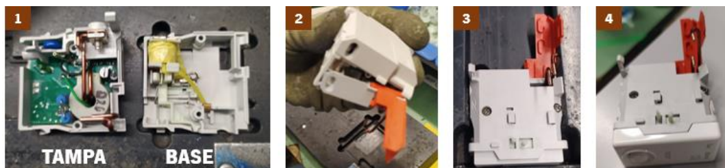
Figura 69 – Montagem da parte diferencial
