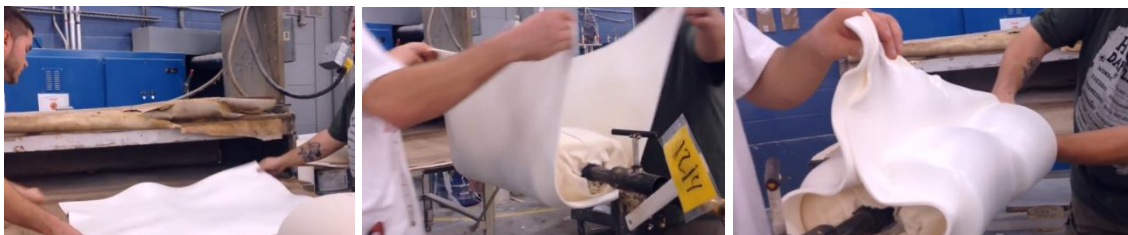
Figura 49 - Processo de produção de colete tradicional
