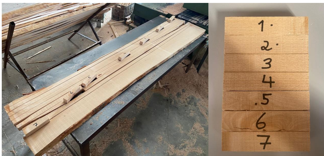
Figura 16 – Extração de sete amostras (barrotes) de uma tábua de Faia
