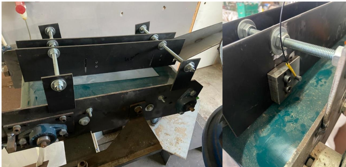
Figura 108 - Colocação das paralelas de guiamento dos cabos e aplicação dos sensores de fibra ótica responsáveis pela análise dos cabos do alimentador e pela contagem
