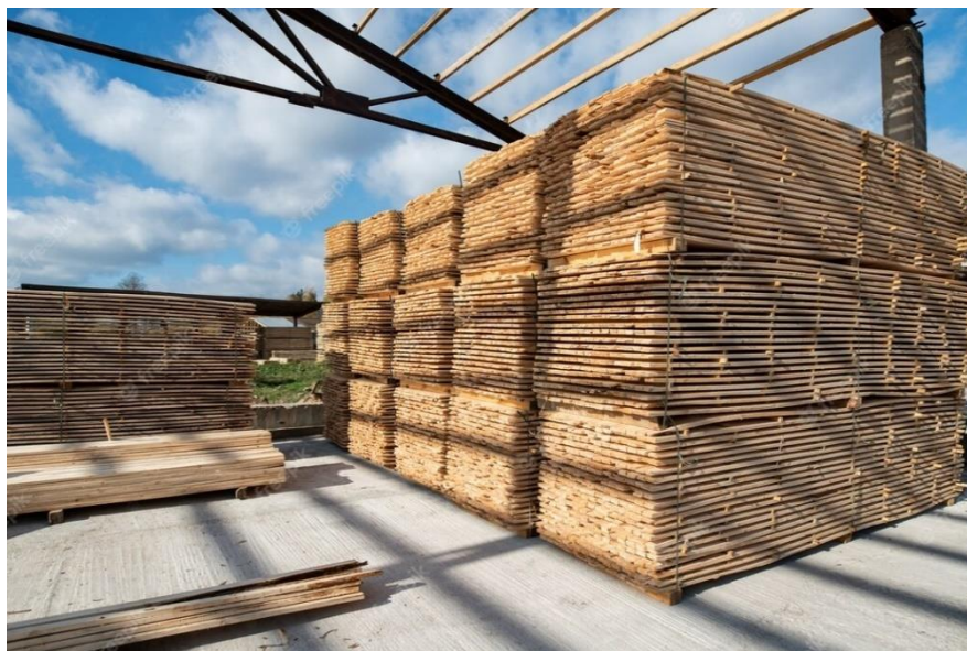
Figura 5 – Paletização das tábuas de madeira para secagem [5]
