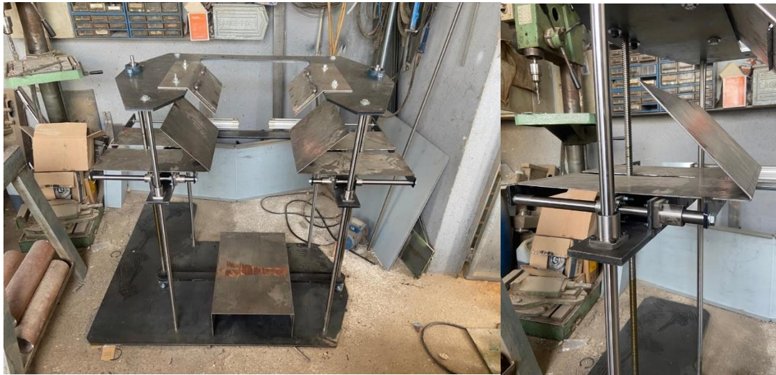
Figura 103 - Fabricação do sistema de embalagem do saco
