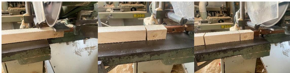
Figura 11 - Aparecimento de uma imperfeição/ Corte evitando a imperfeição/ Corte seguido de um barrote sem imperfeições
