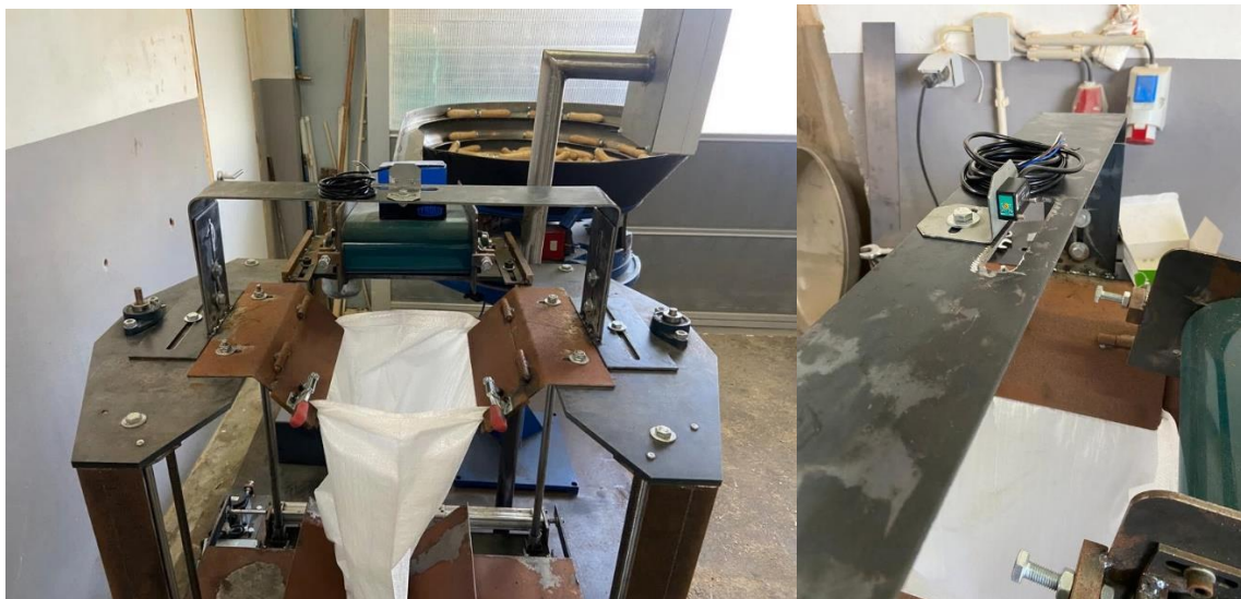
Figura 106 - Implementação do sensor de descida do carrinho e aperto do saco
