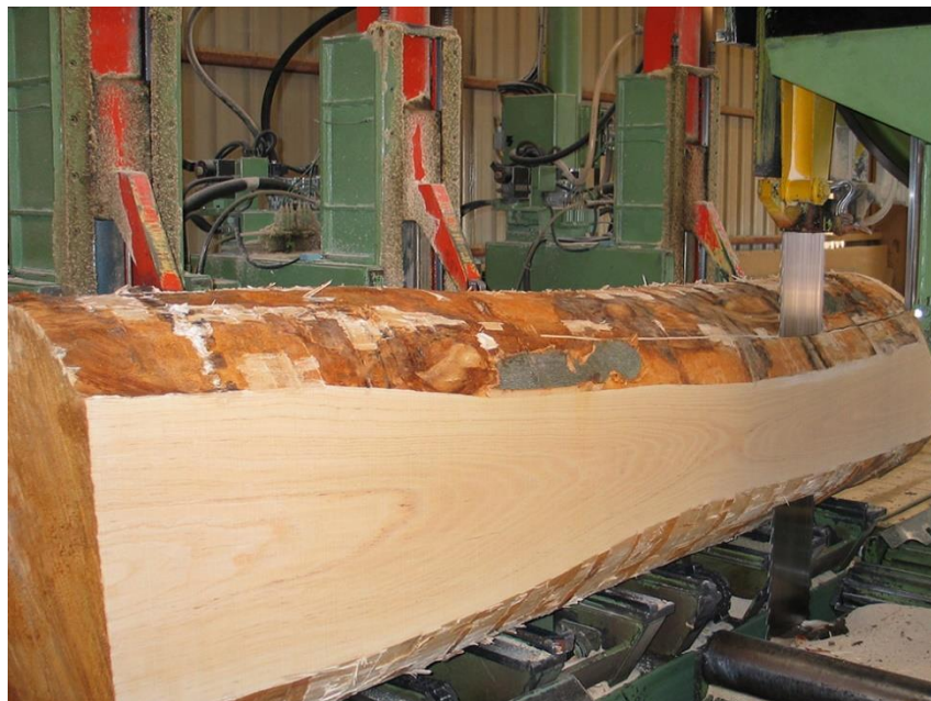
Figura 4 – Corte de toros em tábuas num charriot [4]
