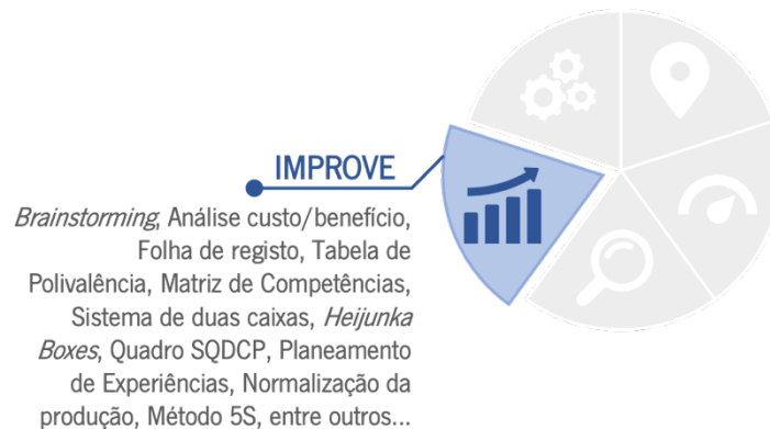
Figura 8: Técnicas e ferramentas usadas na fase Improve do ciclo DMAIC.
