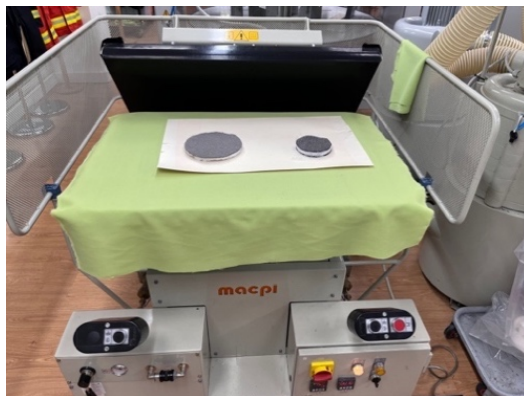
Figura 19. Prensa térmica utilizada para o processo de laminação dos aerogéis.
