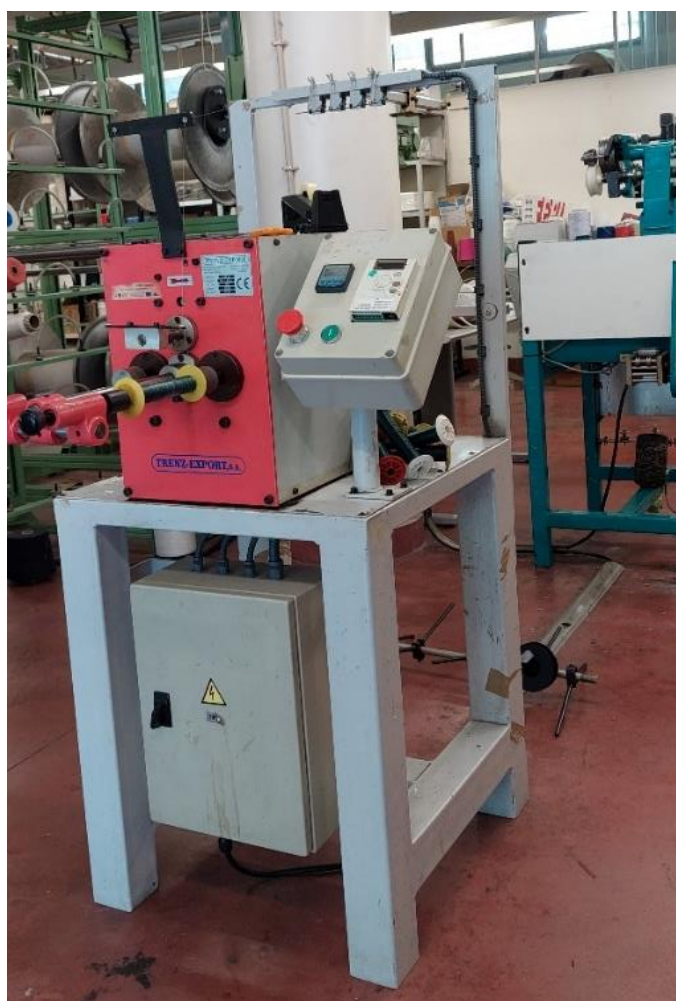
Figura 22. Bobinadeira Trenz-Export modelo PR810 a enrolar um fio de poliamida. Fonte: autor.
