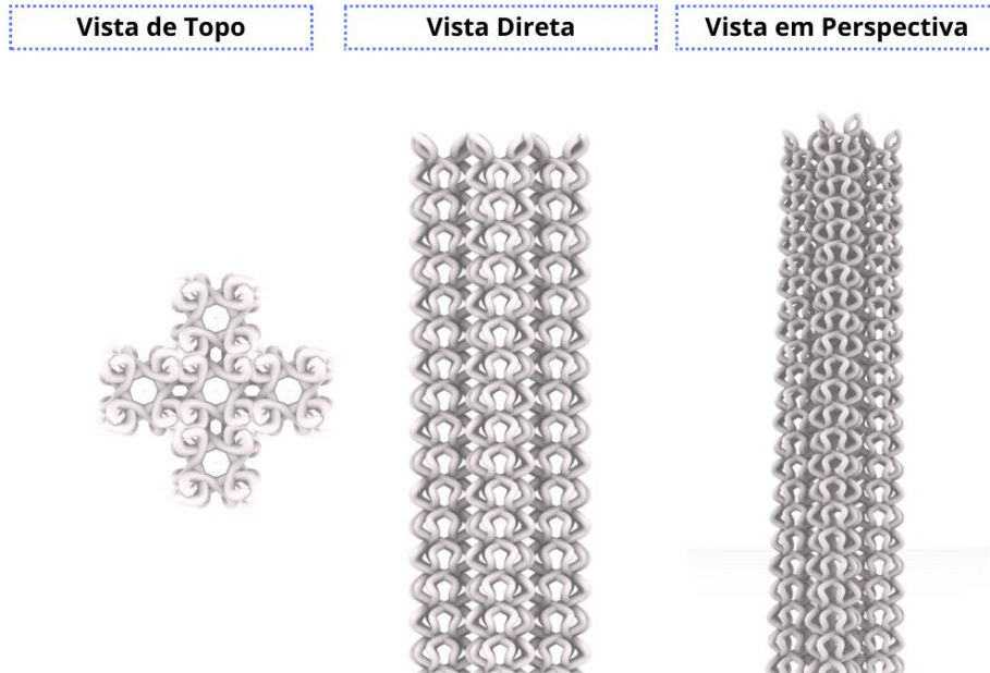
Figura 30. Estrutura entrançada interna (alma) projetada em Rhinoceros 3D® com plugin Grasshopper. Imagem de três vistas possíveis de observação no programa (topo, direta e em perspectivas). Foi projetado um grupo de cinco almas aglomeradas. A superfície da estrutura apresenta porosidade projetada. Fonte: autor.
