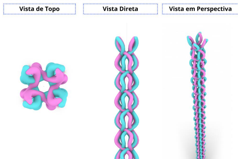
Figura 29. Estrutura entrançada interna (alma) projetada em Rhinoceros 3D® com plugin Grasshopper. Imagem de três vistas possíveis de observação no programa (topo, direta e em perspectivas). Estrutura Regular (2/2), projetada com 8 fios de poliamida de diâmetro 0,40 mm. Diâmetro médio da estrutura 4,40 mm. Fonte: autor.
