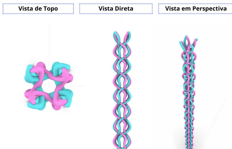
Figura 28. Estrutura entrançada interna (alma) projetada em Rhinoceros 3D® com plugin Grasshopper. Imagem de três vistas possíveis de observação no programa (topo, direta e em perspectivas). Estrutura Regular (2/2), projetada com 8 fios de poliamida de diâmetro 0,30mm. Diâmetro médio da estrutura 3,46 mm. Fonte: autor.
