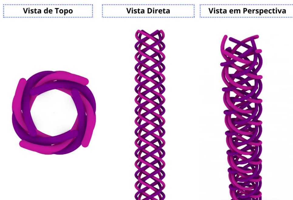
Figura 34. Estrutura entrançada externa projetada em Rhinoceros 3D com plugin Grasshopper. Imagem de três vistas possíveis de observação no programa (topo, direta e em perspectivas). Estrutura Regular (2/2), projetada com 8 fios de poliamida de diâmetro 0,50 mm. Fonte: autor.
