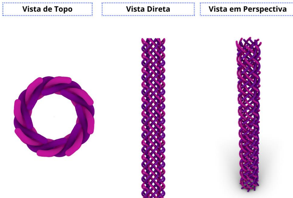
Figura 33. Estrutura entrançada externa projetada em Rhinoceros 3D com plugin Grasshopper. Imagem de três vistas possíveis de observação no programa (topo, direta e em perspectivas). Estrutura Regular (2/2), projetada com 16 fios de poliamida de diâmetro 0,50 mm. Fonte: autor.
