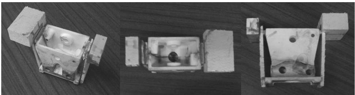
Figura 20 – Modelo preparado para receber o revestimento cerâmico que vai constituir a moldação
