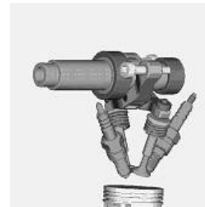
Figura 3 - Detalhe das partes móveis da cabeça do cilindro
