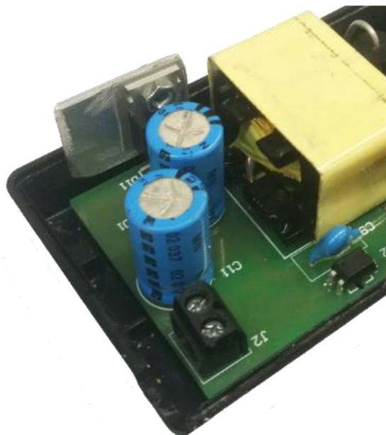
Figura 5.16 – Lado secundário do conversor CC-CC unidirecional isolado *flyback*.
