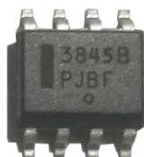
Figura 5.3 – Controlador adotado *UC3845* do fabricante *Texas Instruments*.
